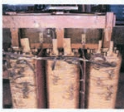
شکل(۳-۲۴) در سیم پیچ های نا سالم یکنواختی رنگ موجود نیست
