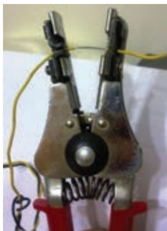
شکل (۱-۴) برداشتن روکش سیم‌ها
