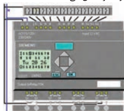
اتصال موقت به طریق ترمینال‌ها
