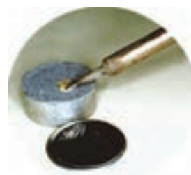
د- تمیز کردن سر هویه
