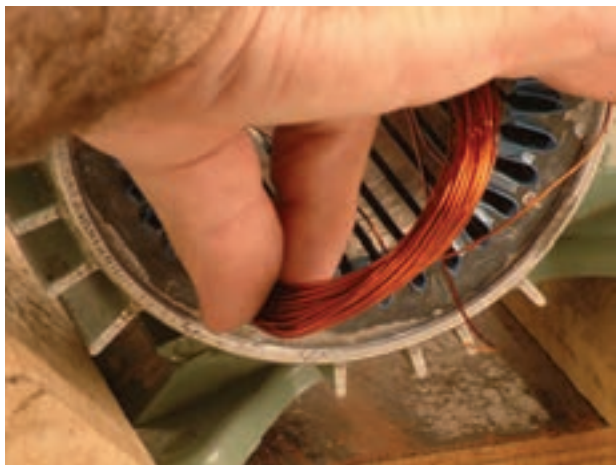
شکل ۲-۱۵- قرار دادن بازوی شماره یک در شیار شماره ۱
