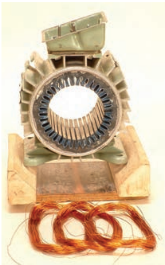
شکل ۲-۱۴- تعیین محل قرار گرفتن کلاف ها
