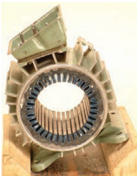
شکل ۲-۱۳- انتخاب شیار شروع و مسیر کلاف‌گذاری
