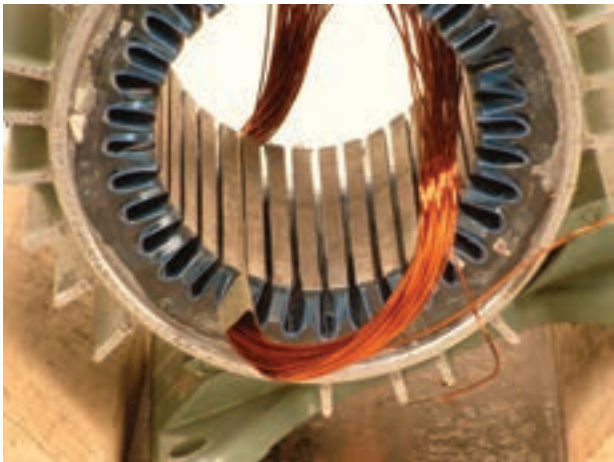
شکل ۲-۹- پوشاندن روی بازوها توسط کاغذ پرشمان
