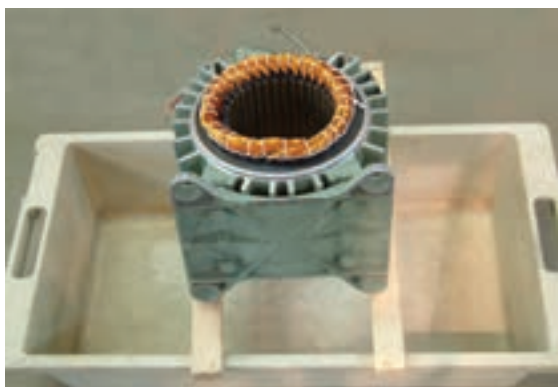
شکل ۴-۲۲- خارج کردن اضافات شارلاک از استاتور
