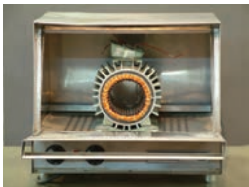
شکل ۲۰-۴ گرم کردن استاتور
