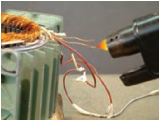
شکل ۴-۱ ب - پاک کردن لاک به روش سوزاندن
