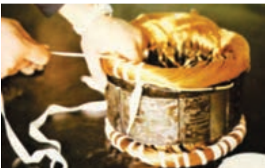
شکل ۴-۱۸– نواربندی سیم‌های استاتور
