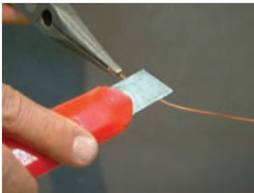
شکل ۴-۱ ج - پاک کردن لاک به روش تراشیدن
