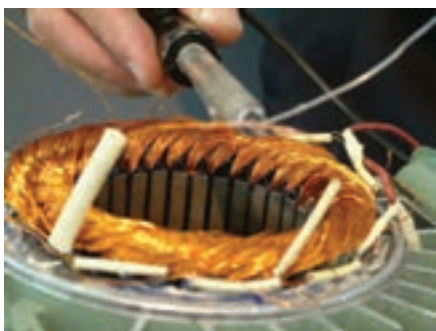
شکل ۷-۴- لحیم کاری محل اتصال سیم ها
