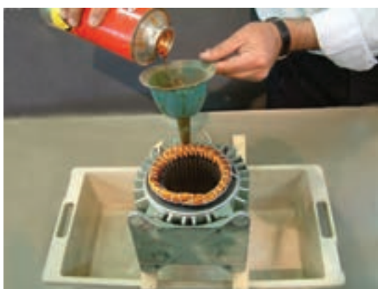
شکل ۴-۲۵- ریختن شارلاک روی سیم‌ها
