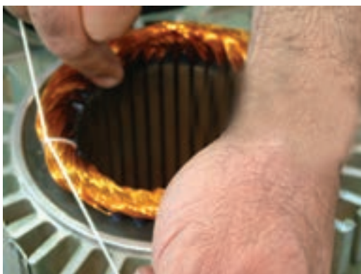
شکل ۴-۱۴- گره زدن یک سر نخ
