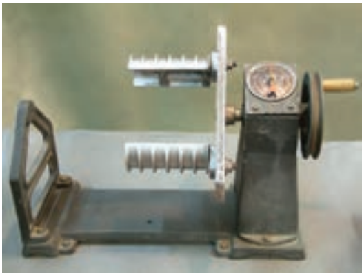
شکل ۳-۱۵- تنظیم اندازه‌ی قالب‌ها در کلاف پیچ
