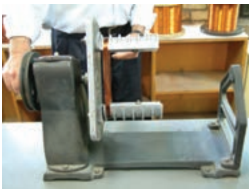
شکل ۱۷-۳- پیچیدن سیم‌ها روی قالب‌ها
