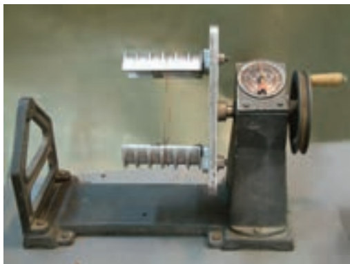
شکل ۳-۵- تنظیم قالب‌ها براساس اندازه‌ی کلاف
