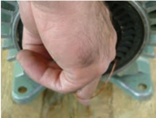
شکل ۳-۱۴- تعیین اندازه‌ی کلاف‌ها با توجه به گام کلاف
