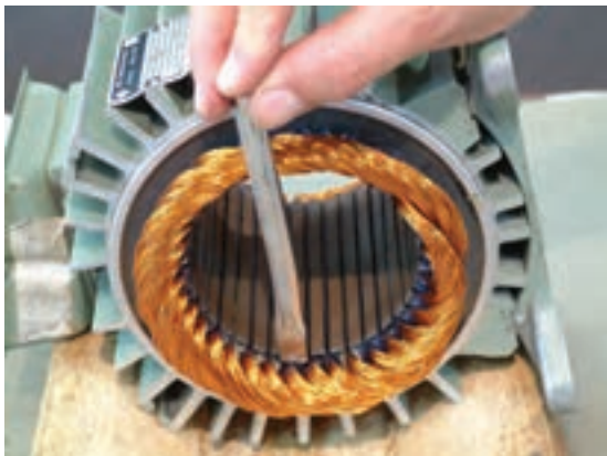
الف - قرار دادن قلم روی سیم‌ها
