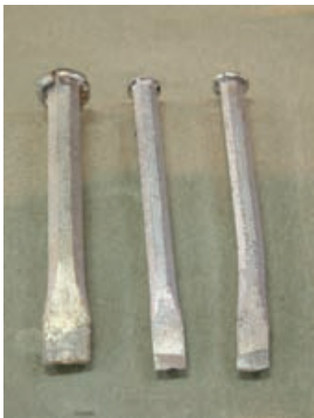
شکل ۲-۱۹- چند نمونه قلم برای بریدن سیم‌ها
