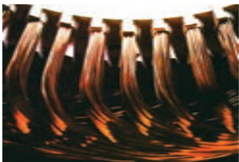
شکل ۲-۳۰- عایق گذاری بین طبقات
