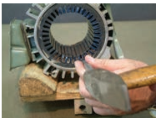
شکل ۲-۲۳ - هدایت سیم‌ها به طرف دوم استاتور
