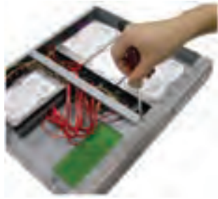
شکل ۳-۶۸ دیسک سخت نصب شده در داخل دستگاه
