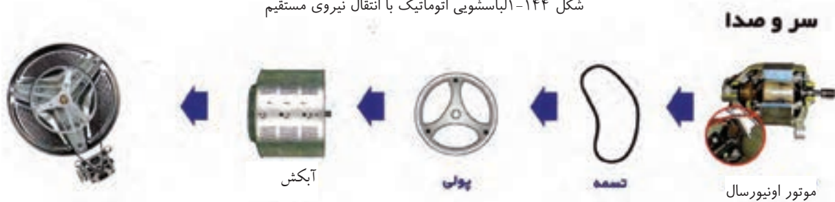
شکل ۱-۱۴۵-الباسشویی اتوماتیک با انتقال نیروی غیرمستقیم
