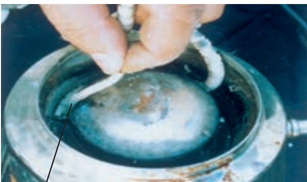
شکل ۲-۲۱ محلی که عایق‌بندی ضعیف است
