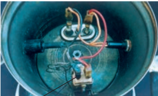
شکل ۲-۱۹ عایق نامرغوب
