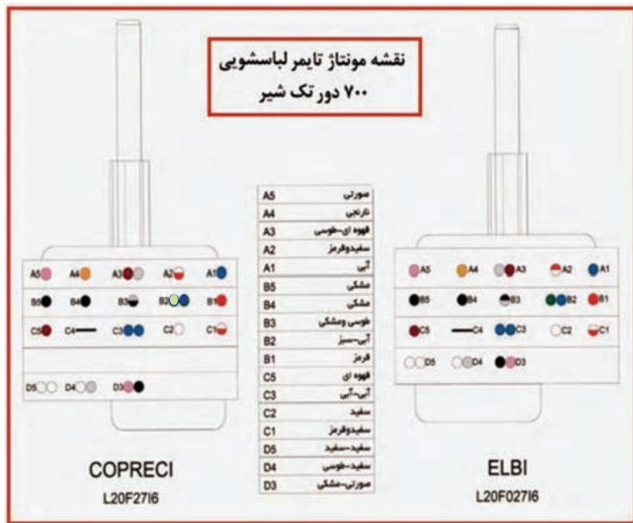
شکل ۱-۱۶۵- نقشه مونتاژ تایمر لباسشویی ۷۰۰ دور تک شیر
