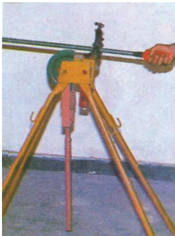
ج - پلیسه‌برداری داخل لوله توسط برقو
