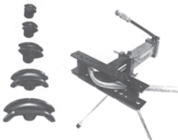
شکل ۴-۷ — لوله خم کن هیدرولیکی به همراه چند نمونه شابلون مربوطه
