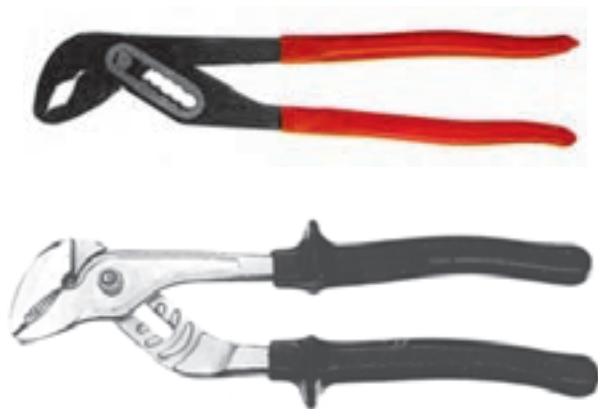
شکل ۴-۱۰ — دو نمونه آچار کلاغی
