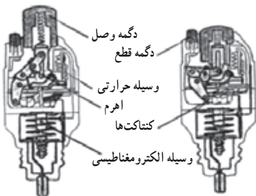
شکل ۱-۶ - ساختمان داخلی فیوز آلفا
