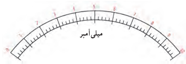
شکل ۵-۷— درجه بندی میلی آمپر متر
