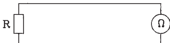
شکل ۵۴-۵- مدار اتصال اهم متر به مقاومت
