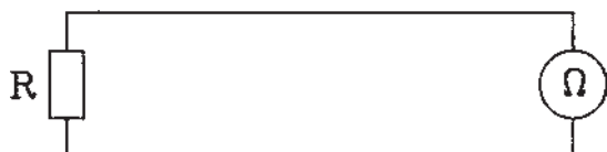
شکل ۵۴-۵- مدار اتصال اهم متر به مقاومت
