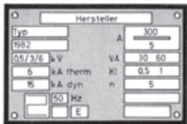
شکل ۵-۶۷ تابلوی مشخصات ترانسفورماتور جریان
