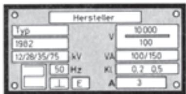
شکل ۵-۶۹ پلاک مشخصات ترانسفورماتور ولتاژ
