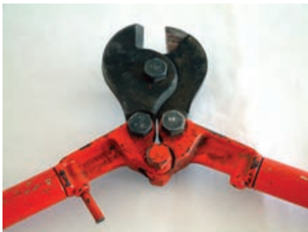
شکل ۵-۷۳- قیچی کابل بری
