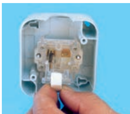
ب - شستی و فنر کلید تبدیل
