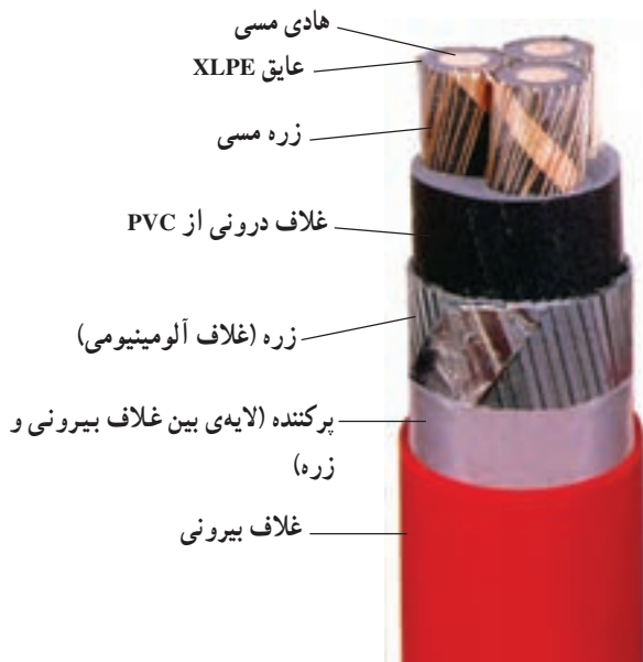
شکل ۵-۷- کابل با غلاف آلومینیومی
