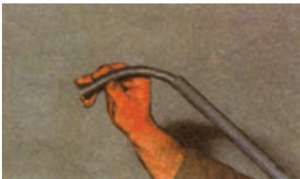
شکل ۴-۴۴ - قرار دادن فنر خم‌کاری در داخل لوله
