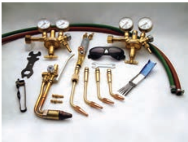
شکل ۱۵-۲ - تجهیزات جوشکاری با شعله‌ی گاز
