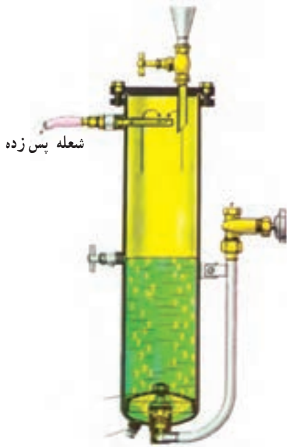
شکل ۲-۴۲- هنگامی که شعله پس می‌زند
