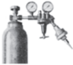
شکل ۲-۴۴- شیر یک طرفه بعد از رگولاتور
