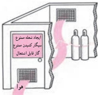
شکل ۲-۸۷ چگونگی بستن کپسول به دیوار و تهویه‌ی انبار کپسول‌ها
