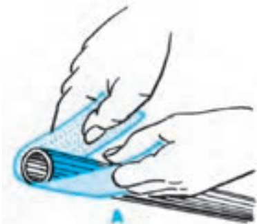
شکل ۴-۱۳- استفاده از کاغذ سنباده جهت پاک کردن چربی و کثافات
