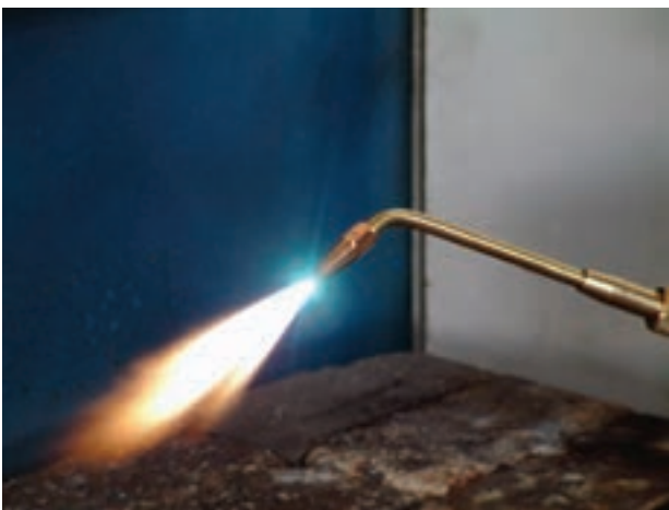
شکل ۲-۳- شعله‌ی سوختن گاز استیلن با اکسیژن
