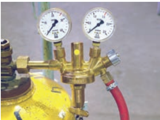
شکل ۱۳۵-۲ پیچ تنظیم فشار استیلن روی رگولاتور
