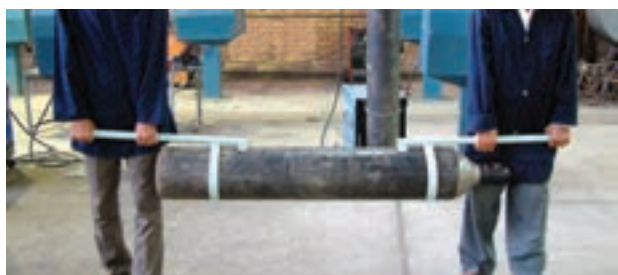
شکل ۲-۸۶ روش درست جابه‌جا کردن کپسول
