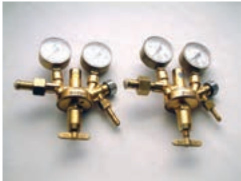
شکل ۲-۴۵- رگولاتور اکسیژن و استیلن
