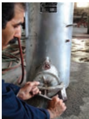
شکل ۲-۳۶ - بستن دریچه‌ی محفظه‌ی کاربید
