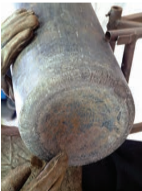
شکل ۱۸-۲- گودی ته کپسول اکسیژن
