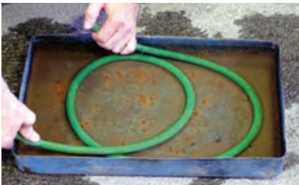
شکل ۲-۹۹- کنترل نشتی شیلنگ در آب
