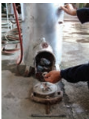
شکل ۲-۳۴ - قراردادن کاربید در محفظه‌ی مخصوص
