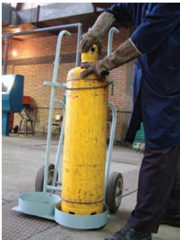
شکل ۱۹-۲- کپسول استیلن و کلاهک آن
