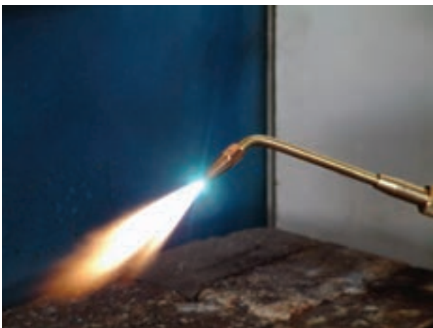
شکل ۲-۳- شعله‌ی سوختن گاز استیلن با اکسیژن
