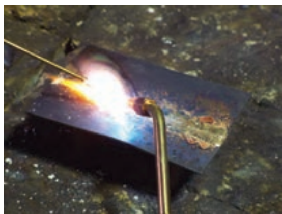
شکل ۴-۷- ایجاد گاز در اطراف محل لحیم کاری
