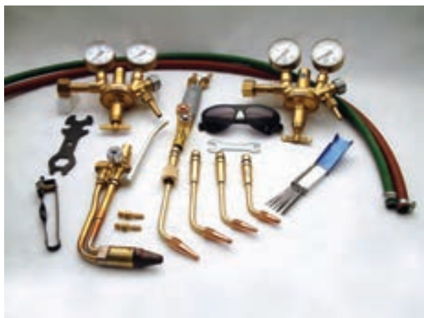
شکل ۱۵-۲- تجهیزات جوشکاری با شعله‌ی گاز
