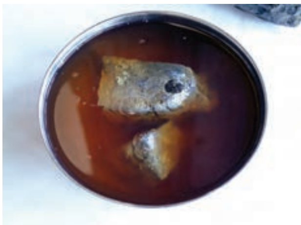
شکل ۱۲-۲ نگهداری کاربید در زیر نفت
