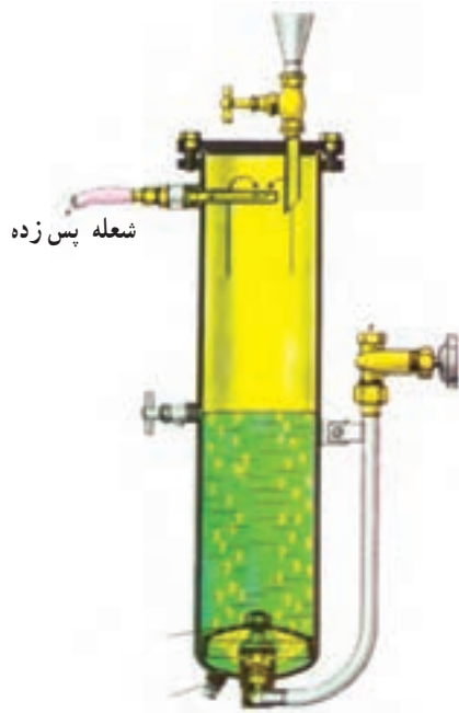
شکل ۲-۴۲- هنگامی که شعله پس می زند
