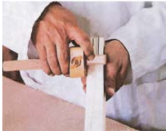
شکل ۵-۵۴- فلکشی با استفاده از فلکش تیزه‌دار.
