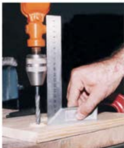
شکل ۱۲-۴۷- آزمایش گونمایی قرار گرفتن دریل.
