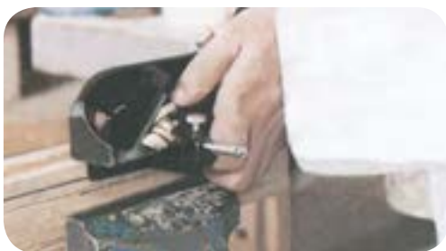
شکل ۶-۷۸. به کارگیری رنده بغل قابل تنظیم.
