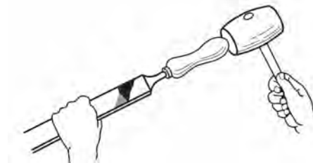
شکل ۱۱-۲۰- شکل جا زدن دسته‌ی چوب‌سا و سوهان.
