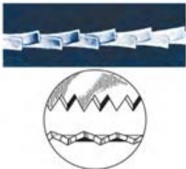
شکل ۱۷-۱۴. دندانه‌های چپ و راست شده.
