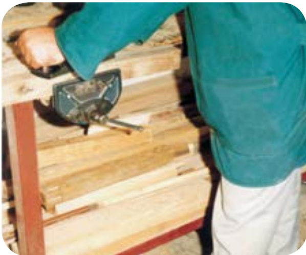
شکل ۶-۷۳- نمونه‌ی ایستادن هنگام رنده‌کاری.
