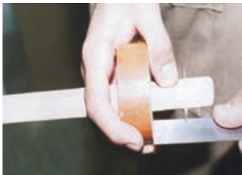
شکل ۸-۳- تنظیم خط کش تیره‌دار، به کمک خط کش فلزی.
