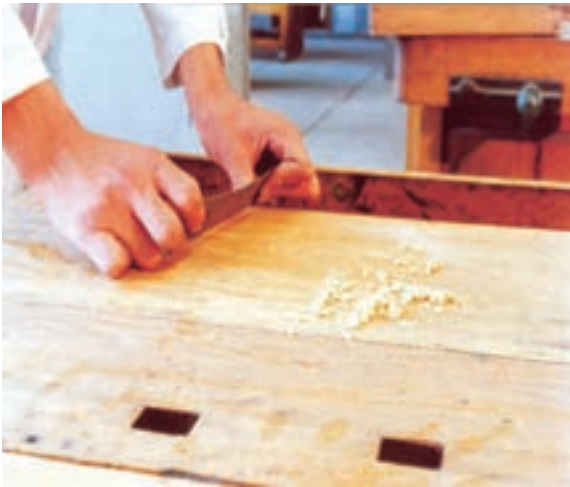
شکل ۲-۱۷- تمیز کردن سطح میز کار با لیسسه.
