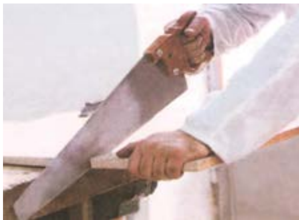
شکل ۵-۸- نمونه‌ی برش به وسیله ارّه دُم روباهی.
