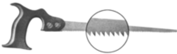
شکل ۵-۱۳- اره نوکی، با بزرگنمایی دندانه‌ها.
