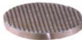
شکل ۷-۲۴- آج روی سر چکش.
