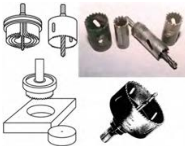
شکل ۱۲-۲۸- سر مته‌ی گردبر و کاربرد آن.
