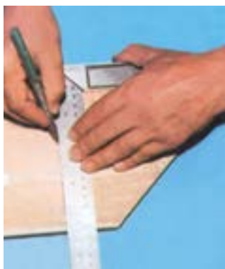
شکل ۶-۱۰۳- استفاده از گونیا برای خط‌کشی.
