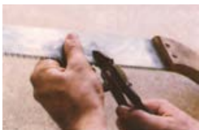
شکل ۱۴-۵۴-۱. فم کردن بقیه دندانها به طرف پایین.
