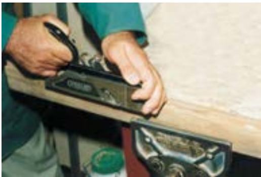
شکل ۶-۷۹. به کارگیری رنده بغل بدون گونیا.
