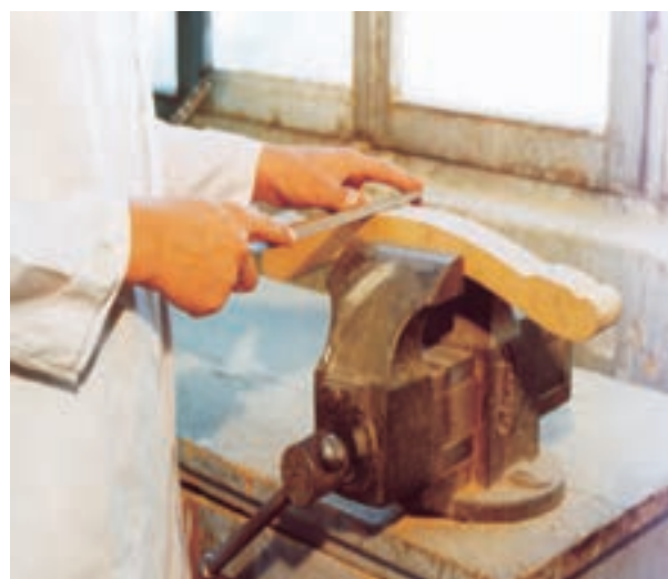
شکل ۲-۱۹- استفاده از گیره‌ی رومیزی برای فرم دادن چوب.
