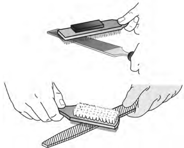
شکل ۱۱-۲۹- تمیز کردن سوهان با برس.
