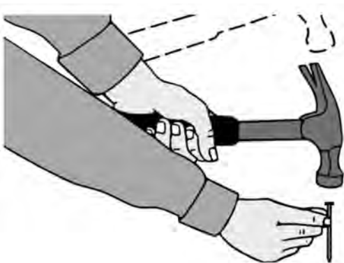
شکل ۳۱-۷. نمونه‌ی گرفتن میخ هنگام کوبیدن.
