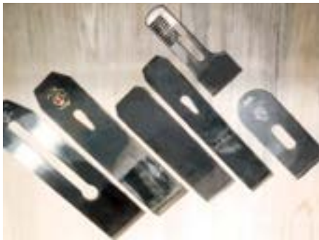
شکل ۶-۱۱- بدنه‌ی تیغه از جنس فولاد، و لبه‌ی برنده‌ی آنها، از فولاد آلیاژی است.
