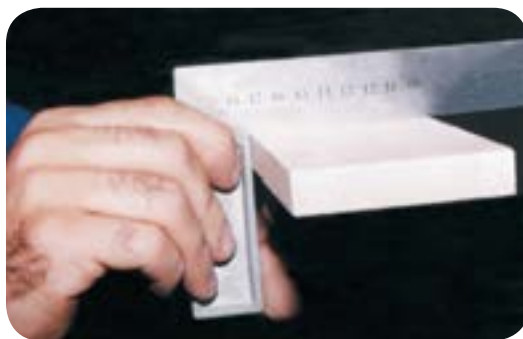
شکل ۶-۷۴. آزمایش صمت رنده‌کاری با گونیا
