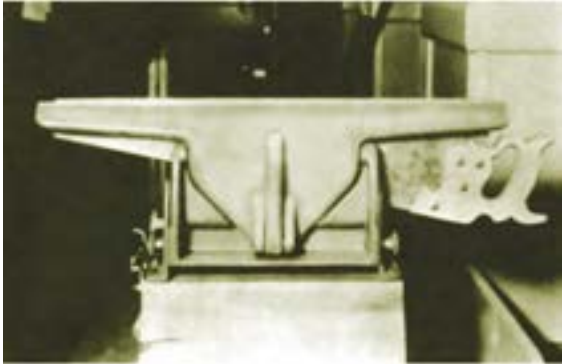
شکل ۱۴-۵۰- قرار دادن ارّه داخل تنگ.
