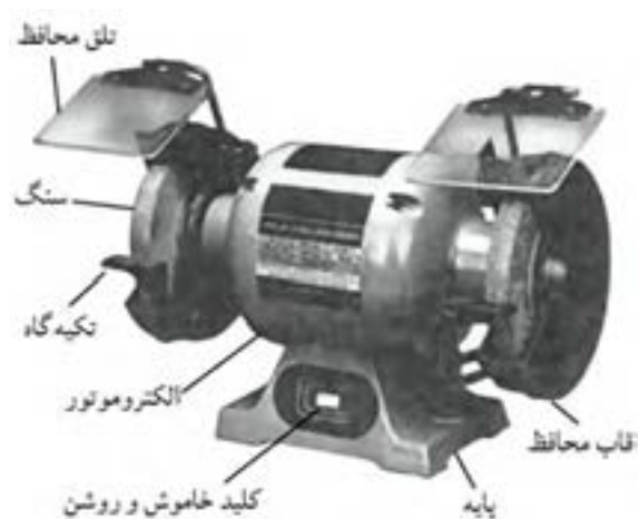
شکل ۱۲-۱۴. قسمت‌های مختلف سنگ سنباده.
