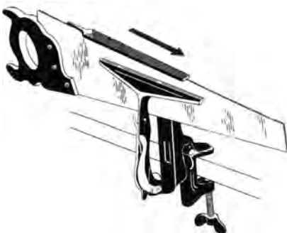
شکل ۱۴-۶۲- میزان کردن دندان‌های اره به وسیله سوهان.
