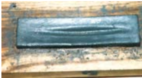
شکل ۴-۱۴- استفاده‌ی نادرست از سنگ نفت.
