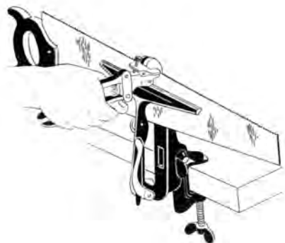
شکل ۱۴-۵۶-۱. انجام عمل چپ و راست کردن به وسیله انبر چپ و راست کن.
