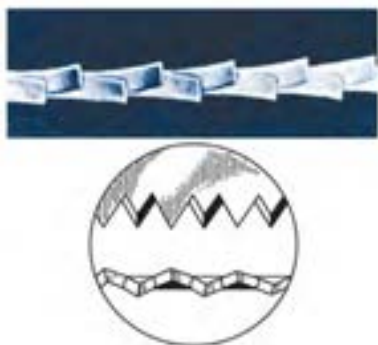
شکل ۱۷-۱۴. دندانه‌های چپ و راست شده.
