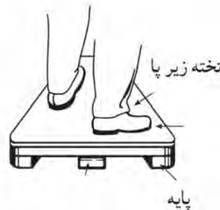
شکل ۱۱-۲۸- استفاده از زیرپایی، هنگام سوهان‌کاری یا چوب‌سا زدن.
