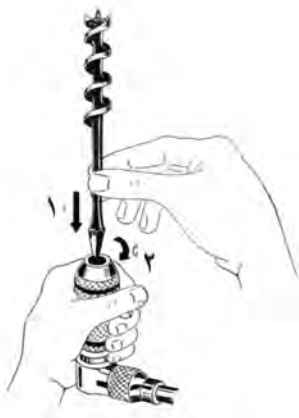
شکل ۱۲-۳۵- بستن سر مته به دریل.
