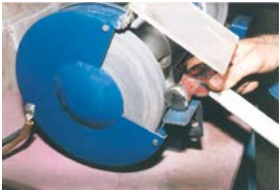
شکل ۷-۴۰- گرفتن پلیسه به وسیله‌ی سنگ سنباده.
