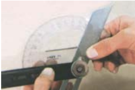
شکل ۱۰۰-۶- استفاده از نقاله در گونیا‌ی تاشو.
