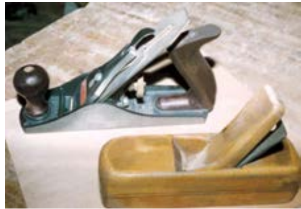
شکل ۶-۱- رنده‌ی چوبی و فلزی.
