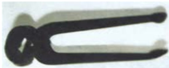
شکل ۷-۲- گاز انبر میخ‌کش.
