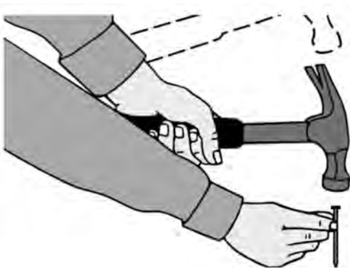
شکل ۳۱-۷. نمونه‌ی گرفتن میخ هنگام کوبیدن.
