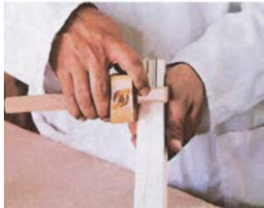
شکل ۵-۵۴- فلکشی با استفاده از فلکس تیزه‌دار.
