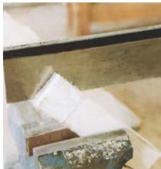
شکل ۵-۵۵- مالت افقی اره در پایان برش.
