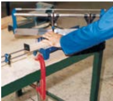
شکل ۵-۶۴- ایجاد برش ۴۵ درجه به وسیله‌ی اژه فارسی‌بُر.
