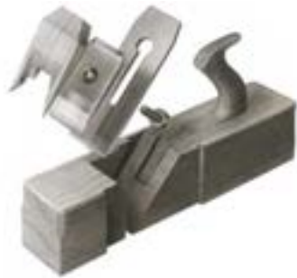
شکل ۱۴-۶. با انداختن تیغه‌ی رنده پوچی.
