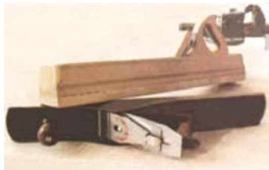
شکل ۶-۴۹- رنده بلند (دستگاه).
