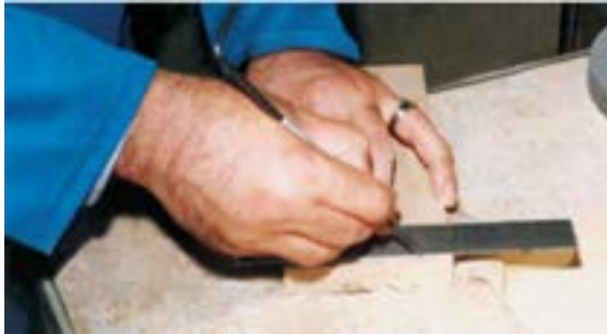
شکل ۶-۸۶- خط‌کشی با استفاده از گونیا.
