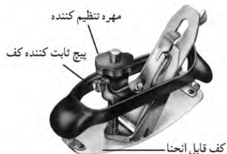
شکل ۴۶-۶- قسمت‌های مختلف رنده کاس و سینه.
