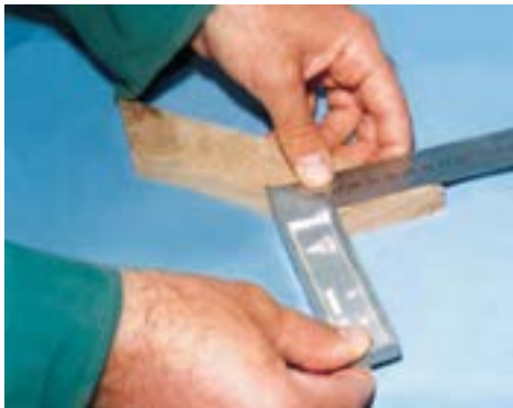
شکل ۵-۶۵- کنترل گونیا‌یی بودن قطعه کار.
