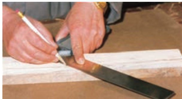
شکل ۶-۹۳- کار کردن با گونیای فارسی.
