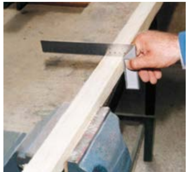
شکل ۶-۸۵- صمت گونیایی بودن قطعه کار با گونیا.
