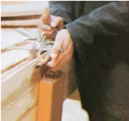
شکل ۸۲-۶. چگونگی کار با رنده کنشکاف.
