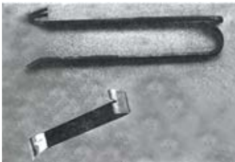
شکل ۷-۵- دو نوع دیلم میخ کش.
