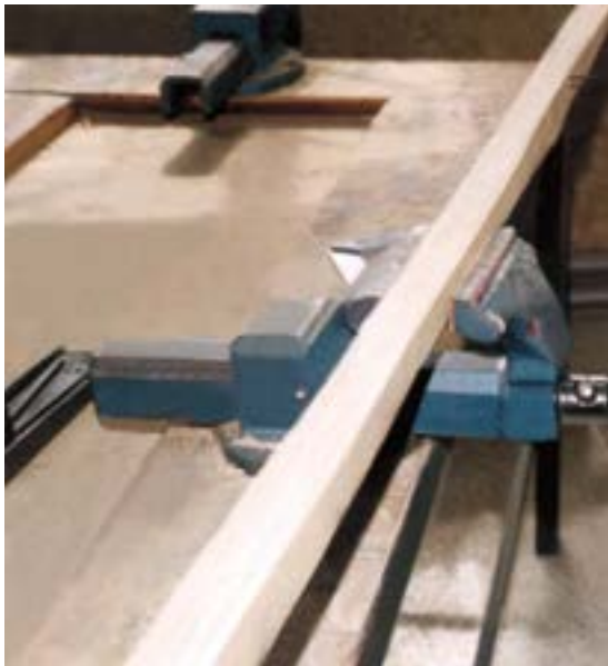
شکل ۸۳-۶. بستن قطعه کار به گیره میز کار.
