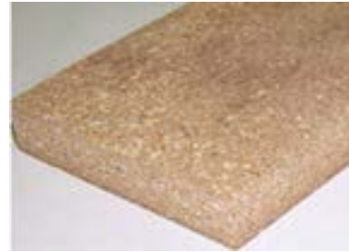
شکل ۳-۱۴۳- تفتنه فرده چوب یک لایه.
