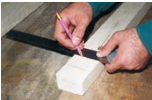
شکل ۵-۴۸- فم‌کشی قطعه کار به‌وسیله‌ی گونیا و مداد.
