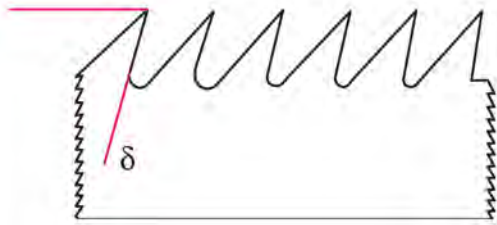
شکل ۵-۳۴- زاویه‌ی برش، کمتر از ۹۰ درجه.
