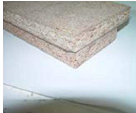
شکل ۳-۱۴۵- تفتنه فرده چوب با لایه‌های تدریجی.
