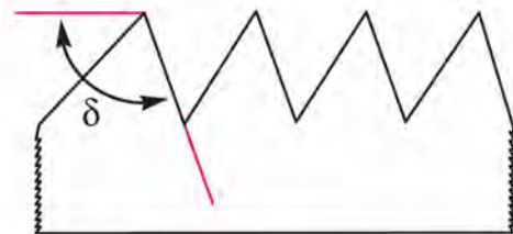
شکل ۵-۳۳- زاویه‌ی برش \delta بیشتر از ۹۰ درجه.
