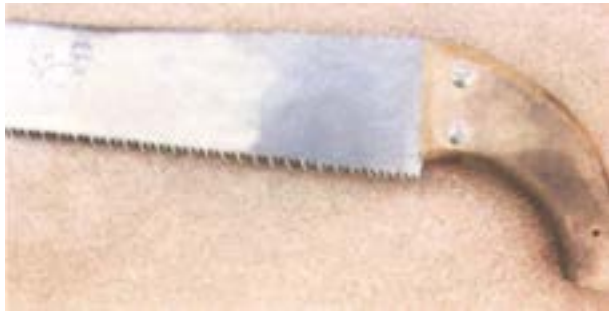
شکل ۵-۳- اره‌ی دندان‌رو به عقب.
