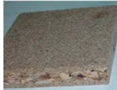
شکل ۳-۱۴۴- تفتنه فرده چوب سه لایه.
