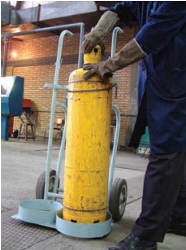
شکل ۲-۱۹- کپسول استیلن و کلاهک آن
