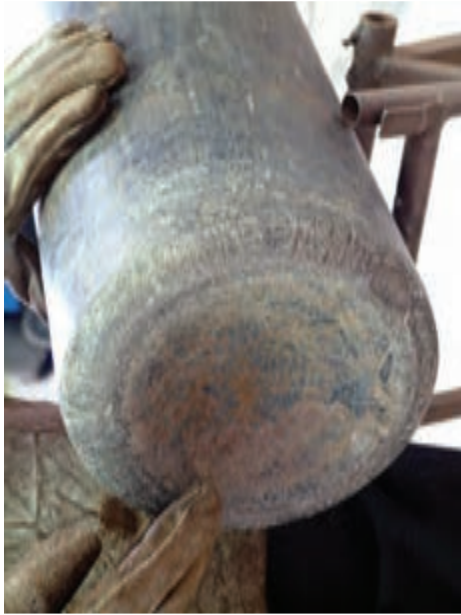
شکل ۲-۱۸- گودی ته کپسول اکسیژن
