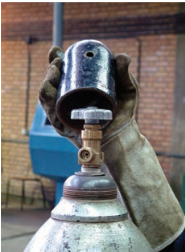
شکل ۱۷-۲- کلاهک کپسول اکسیژن
