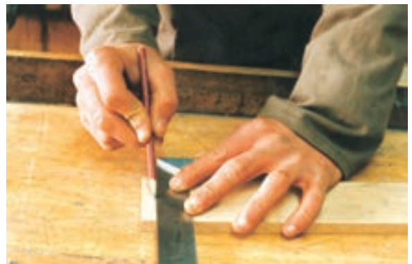
شکل ۹-۶۳- فم کشی ممل اتصال با گونیا.
