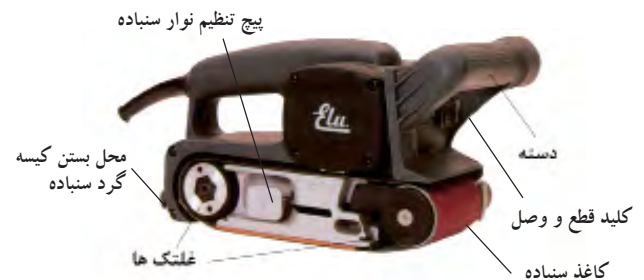
شکل ۷-۵- اجزای مهم و کاربردی دستگاه سنباده نواری.
