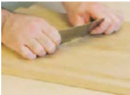
شکل ۲-۱۳- جهت حرکت لیسه، هنگام پُرزگیری.
