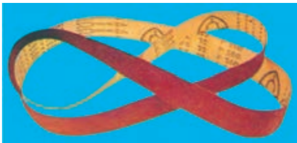
شکل ۷-۳۰- از انواع سنباده‌های نواری آماده می‌توان برای آماده‌سازی دستگاه سنباده کمک گرفت.
