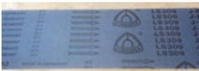
شکل ۷-۳۲- هنگام سوار کردن نوار سنباده روی دستگاه، به جهت فلش‌ها و حرکت غلتک‌ها توجه کنید.
