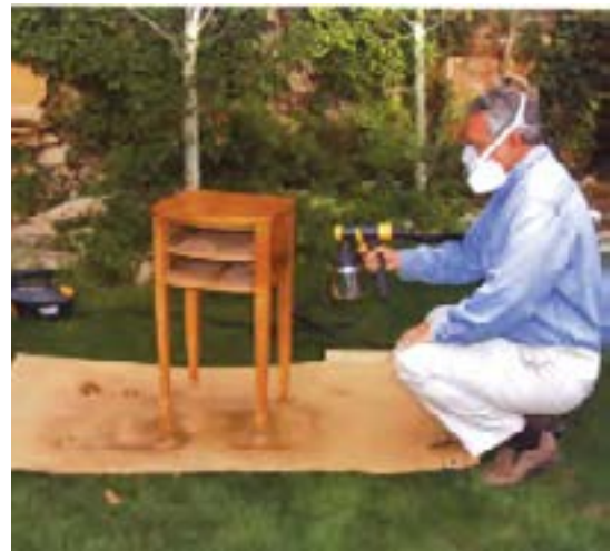
شکل ۲۳-۴. رنگ‌کاری با پیستوله (رنگ پوششی).
