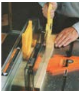
شکل ۳-۱۲- استفاده از وسایل کمکی در هنگام کار.
