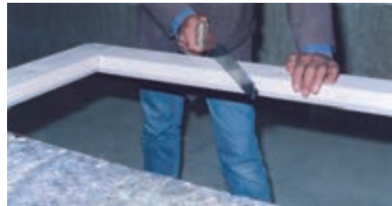
شکل ۱۱-۲۶- ایجاد شیار با اره‌ی دستی.
