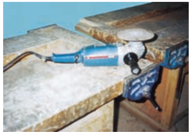
شکل ۷-۴۲- چگونگی قرار ایمنی دستگاه سنباده بشقابی (روی میز کار).
