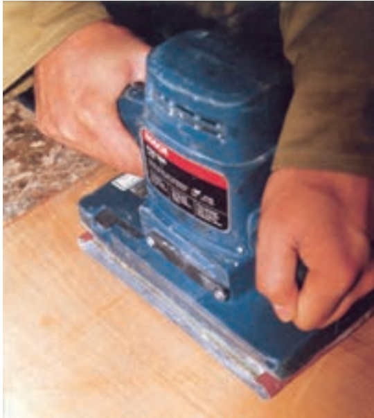
شکل ۷-۱۱. سنباده کاری در جهت الیاف.
