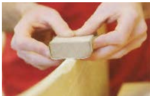
شکل ۳-۲۱. طریقه‌ی سنباده‌کاری نر قطعات با دو دست.
