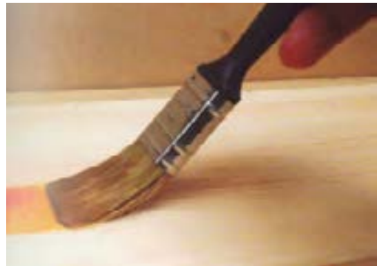
شکل ۴-۴۳- قلم‌مو را در جهت الیاف چوب بکشید.
