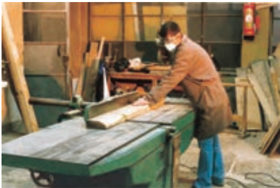
شکل ۹-۹- مقدار باز بودن زیاد گونیا، فطرآفرین است.
