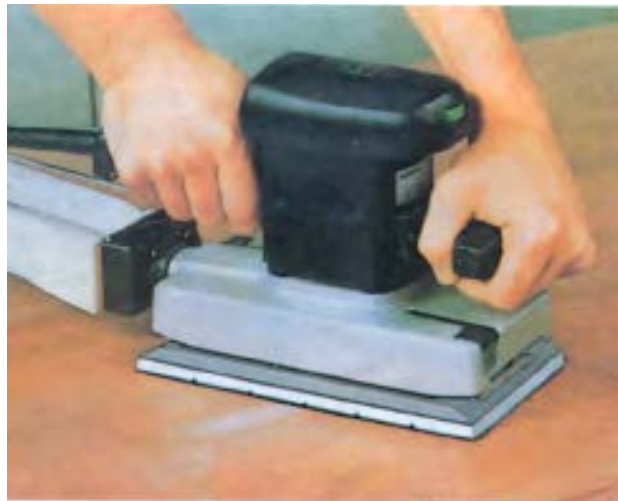
شکل ۳-۱۴- سنباده‌زنی با یک دستگاه سنباده لرزان کامل.
