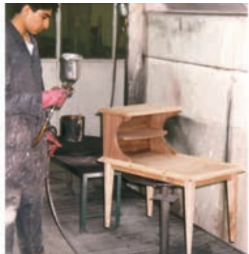
شکل ۲۴-۴. رنگ‌کاری با پیستوله (رنگ شفاف).
