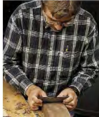
شکل ۲-۳۰- پرداخت سطوح قوس دار به وسیله لیسه.
