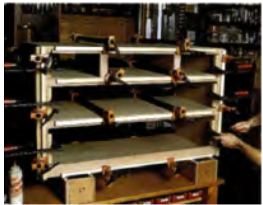
شکل ۱-۵۰. هنگام مونتاژ کابینت‌ها می‌توان برای ممک کردن و گرفتن دوئیدگی، از تنگ و پیچ‌دستی در جهات افقی و عمودی استفاده نمود.
