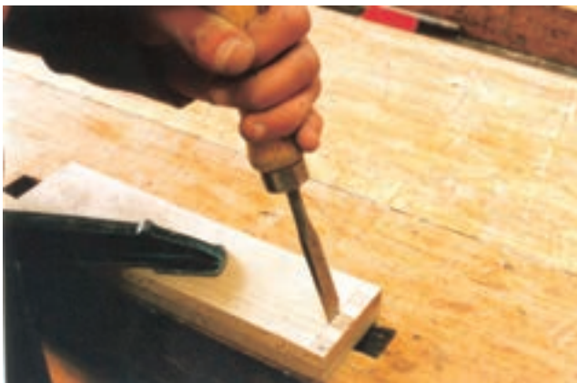
شکل ۹-۶۶- فالی کردن ممل فاق و زبانه با مغار و پکش چوبی.
