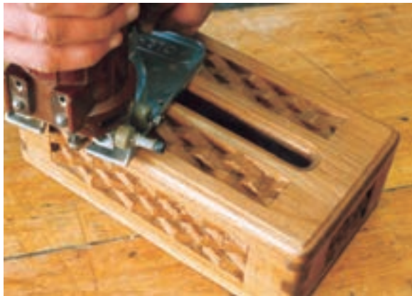
شکل ۹-۷۱- فرز کاری لبه‌های کار و شیار محل فروج دستمال کاغذی.
