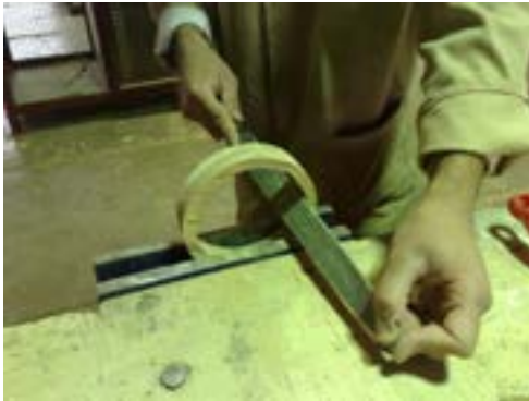
شکل ۱۹۳-۱۲. پرداخت ملقه‌ی چوبی.
