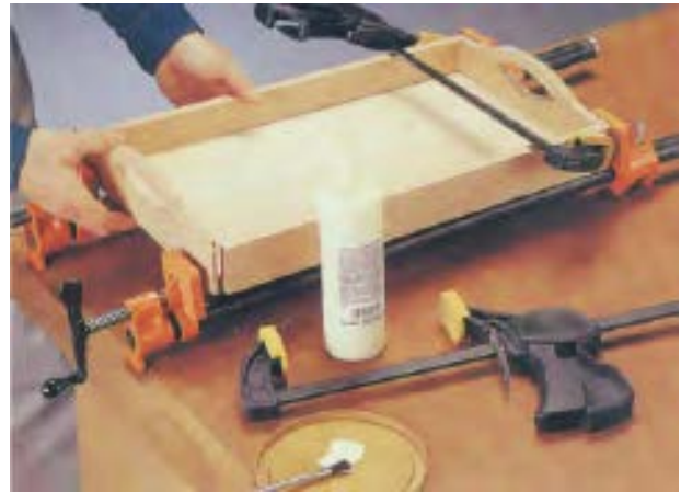
شکل ۱۴۳- برای چسباندن قطعات بزرگ، می‌توان از تنگ دستی استفاده نمود.
