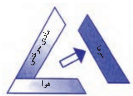
شکل ۱۵-۱- سرد کردن ماده‌ی سوختنی
