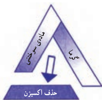
شکل ۱۶-۱- ممانعت از رسیدن اکسیژن به ماده‌ی سوختنی
