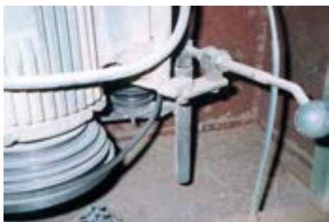
شکل ۳-۱۵- اهرم الکتروموتور، آزاد است.
