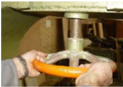
شکل ۳-۲- فرمان جابجایی (بالا و پایین) فلکه اره. حفاظ‌های روی فلکه و تیغه، باز شود (شکل ۴-۲).
