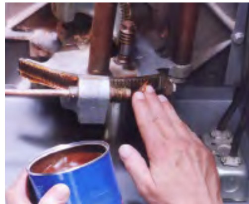
شکل ۱۲-۳۴- گریس‌کاری یرغ دنده‌ها.
