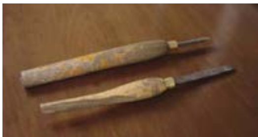
شکل ۱۱-۲۰- نمونه‌ای از مغارهای با دسته‌ی معیوب.
