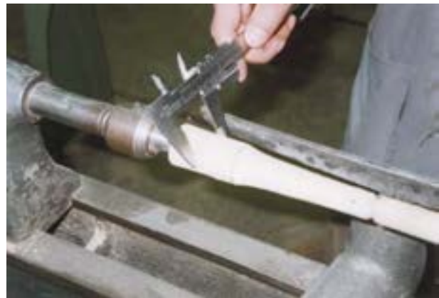
شکل ۱۱-۶۶- اندازه‌گیری و کنترل قطر قطعه کار در قسمت‌های مختلف.
