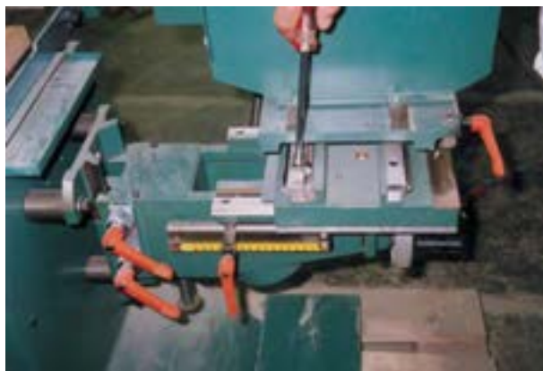
شکل ۱۰-۱۴- کنترل پیچ‌های دستگاه هدایت.
