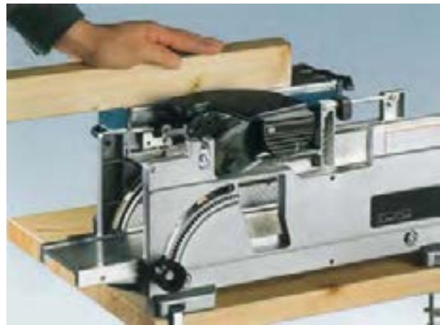
شکل ۱۴-۲۰- کاربرد میز کمکی در موقع رندیدن.
