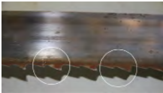
شکل ۱-۶۷-۱- فاصله (گام) دندانها کم و زیاد شده است.
