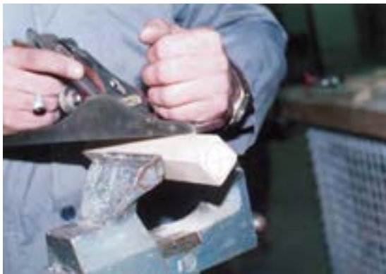
شکل ۱۱-۵۳- مراحل آماده‌سازی چوب برای فرایندی کردن.
