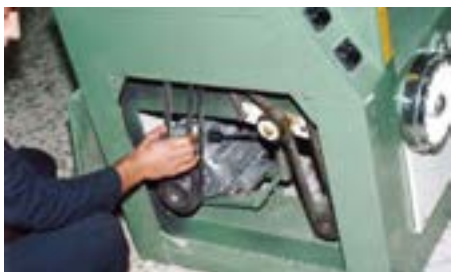
شکل ۲۶-۷. کنترل سفتی تسمه‌ی انتقال نیرو.
