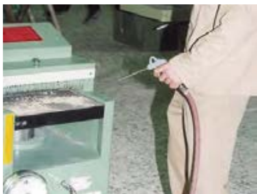
شکل ۸-۱۲- گردگیری و نظافت سطوح ماشین با هوای فشرده.
