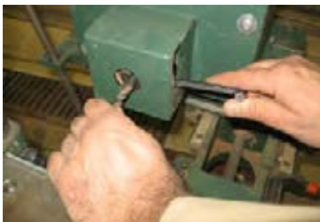
شکل ۹-۱۷- ممکن کردن مته داخل سه‌نظام.
