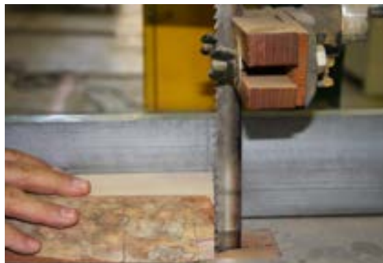
شکل ۳۲-۱- شرایط ایمنی دست، هنگام کار با اره.
