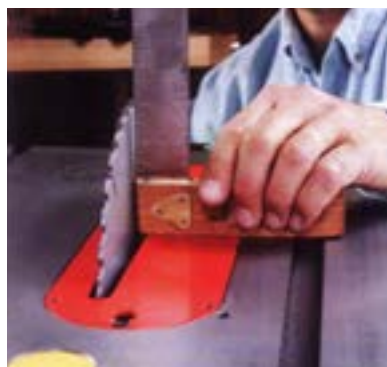
شکل ۱۶-۱۲- کنترل زاویه‌ی تیغه.
