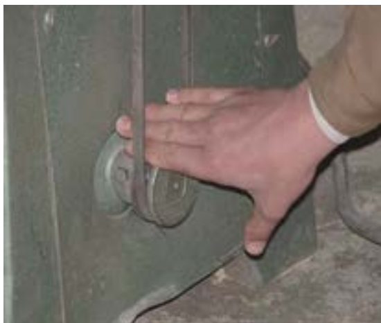
شکل ۱۰-۶- مراقبت از انگشتان به هنگام تعویض تسمه.
