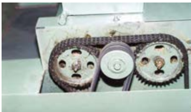
شکل ۱۸-۷. زنجیر انتقال نیرو و قدرت به غلتک‌ها.
