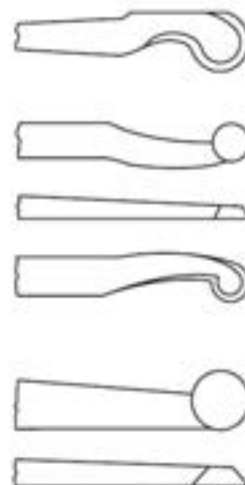
شکل ۱۱-۱۷- مغار(های) مخصوص سطوح مقعر و فضای داخلی.
