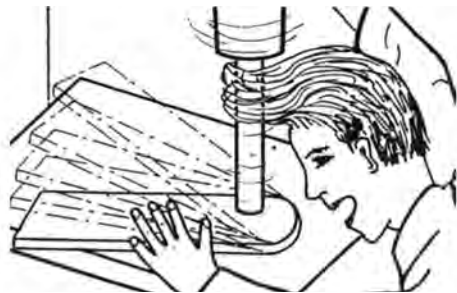
شکل ۱۹-۲۶- درگیر شدن مته با موی سر.
