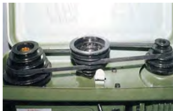
شکل ۱۹-۱۳- تغییر دور پله‌ای در دستگاه دریل ستونی.
