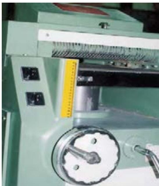
شکل ۷-۴۱- این ماشین، به دو کلید مجهز است.
