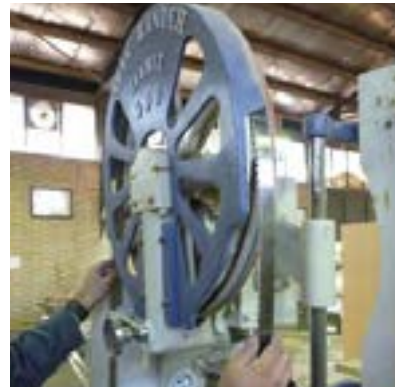
شکل ۱-۲۱-۱- استقرار صحیح تیغه روی فلکه‌ها و تنظیم‌های لازم.
