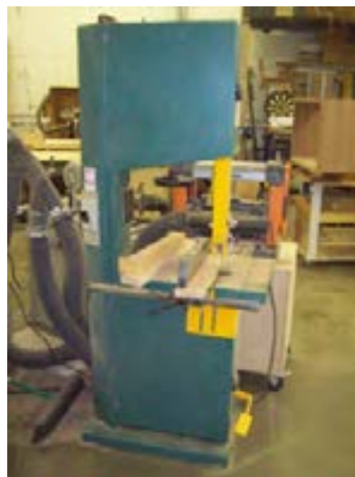
شکل ۹-۱. یک ماشین اره‌نواری، با مفاظ کامل.
