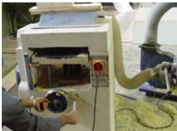
شکل ۷-۴۰- تنظیم دهانه‌ی گندگی.
