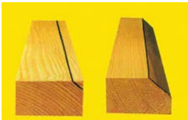
شکل ۳۰-۱۴- چوب فطاکشی شده و پیغ فورهده. فط ترسیمی، تا آفرین لمظه باقی می‌ماند.
