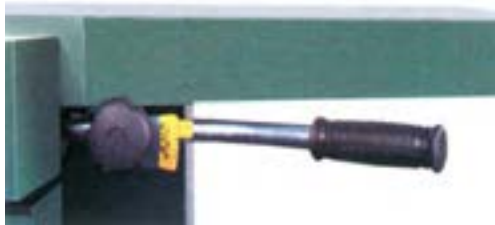
شکل ۸-۴- اهرم تنظیم بار صفحه‌ی کفرند.
