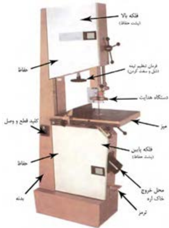
شکل ۴۱-۱. قسمت‌های مختلف یک ماشین اره‌نواری.
