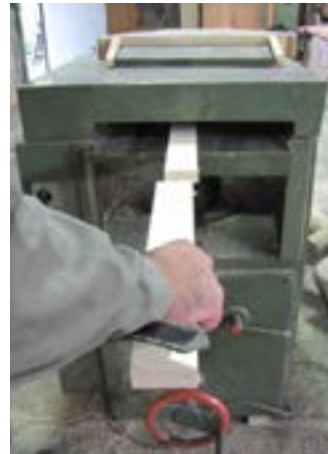
شکل ۷-۳۲- روش صحیح وارد کردن چوب.
