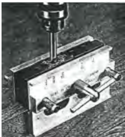
شکل ۱۹-۵۶- سوراخ‌کاری با استفاده از شابلن.
