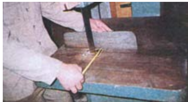
شکل ۱-۴۳-۱- اندازه‌گیری فاصله تیغه با گونیا.
