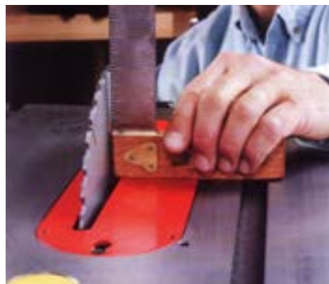
شکل ۱۲-۲۲- کنترل و تنظیم گونیایی بودن تیغه.
