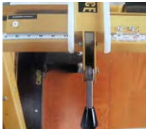
شکل ۱۲-۲۳- تنظیم اندازه‌ی برش.
