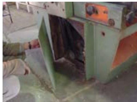
شکل ۹-۶ حفاظ تسمه در جای خود قرار گیرد.
