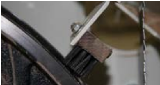
شکل ۸-۱- برس غبارگیری روی بانداژ فلکه.
