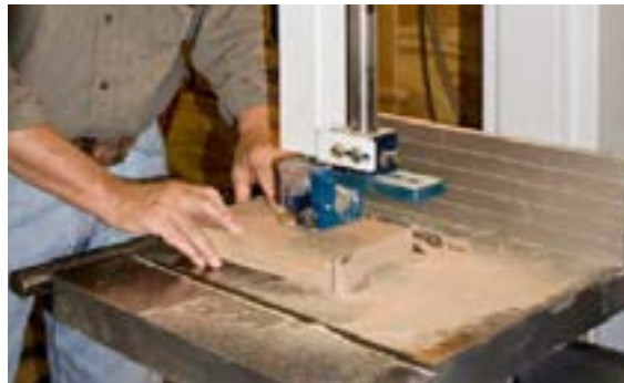
شکل ۱-۳۵-۱- فاصله‌ی ارتفاع سطح چوب با دستگاه هدایت.
