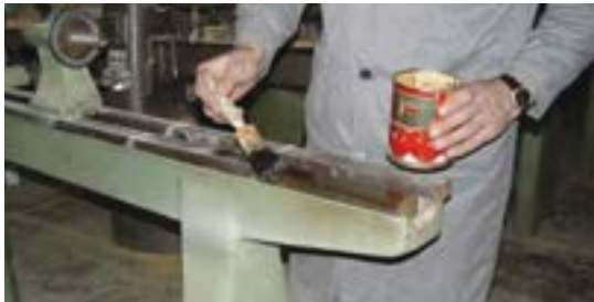
شکل ۱۱-۴۵- تمیزکاری قسمت‌های ضروری و بدون رنگ ماشین.
