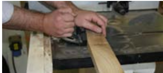
شکل ۱۳-۱- گونیا‌ی متغیر و مدرج، برای برش عرضی.
