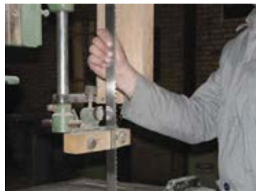
شکل ۵۱-۱- کنترل سفتی تیغه به کمک دست.
