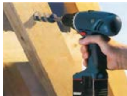
شکل ۱۹-۹- دریل شارژی برای مکان‌هایی که برق در آنجا وجود ندارد.
