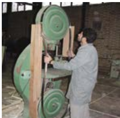
شکل ۵-۲- خارج کردن تیغه اره از روی فلکه‌ها. باید یک تیغه‌ی تیز که دارای چپ و راست صحیح می‌باشد، متناسب با نوع کار و جنس چوب انتخاب کرد.
