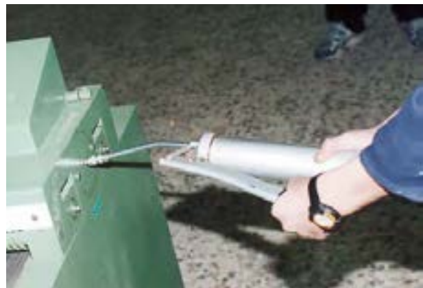
شکل ۸-۱- گریس‌کاری بلبرینگ یاتاقان‌ها.
