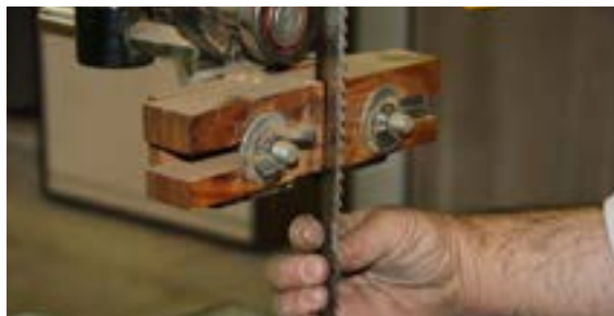
شکل ۳۴-۱- کنترل لازم تیغه قبل از کار.
