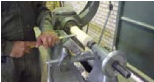
شکل ۱۱-۱۰- تکیه‌گاه کوپک مغار، برای قطعات کوتاه.
