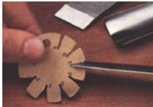
شکل ۴-۵- شابلن مخصوص کنترل زاویه‌ی رنده.
