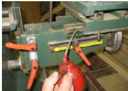
شکل ۱۰-۱- (روغن‌کاری ریل‌ها و کشوهای صفحه‌ی متمرک).
