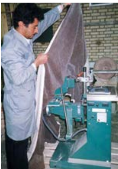
شکل ۱۸-۱۰- نمونه‌ی پوشاندن ماشین از نفوذ گرد و غبار.
