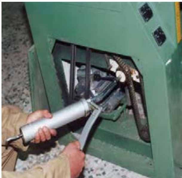
شکل ۸-۷- گریس‌کاری ممبرهای انتقال نیرو.
