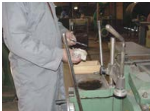
شکل ۱۰-۵- (روغن‌کاری و تمیز کردن مته‌ها).
