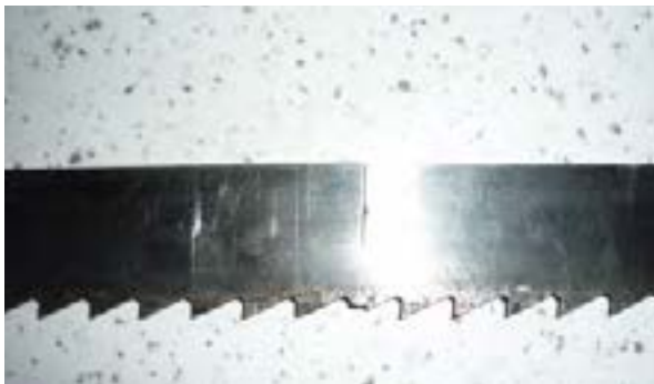
شکل ۷۰-۱- ترک تیغه اره از محل جوش.
