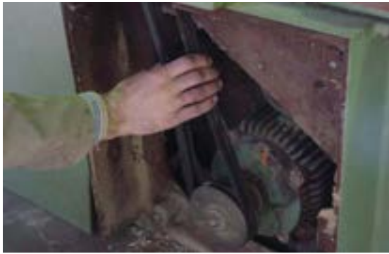
شکل ۱۳-۶- سفتی تسمه را بررسی کنید.
