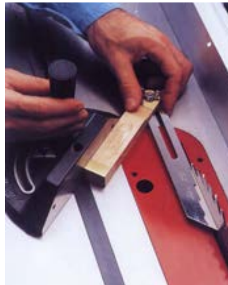
شکل ۲۰-۱۲- تنظیم زاویه‌ی تیغه
