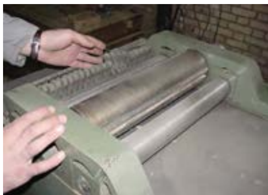
شکل ۷-۲۹- کنترل تمیزی شانه‌ها.
