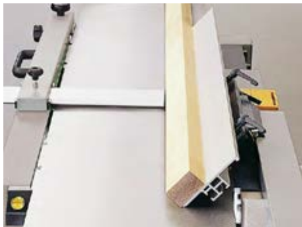
شکل ۴-۲۸ - رندیدنِ تمت (زاویه‌ی چوب، به وسیله‌ی گونبای تمت زاویه‌ی کفرند).
