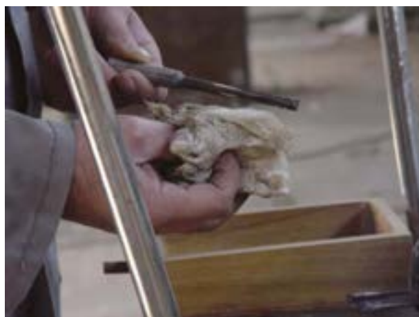
شکل ۱۶-۱۰- تمیز کردن مته‌های خارج شده از ماشین.
