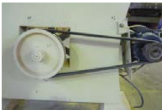
شکل ۳-۱۷- استقرار تسمه در داخل چرخ تسمه.
