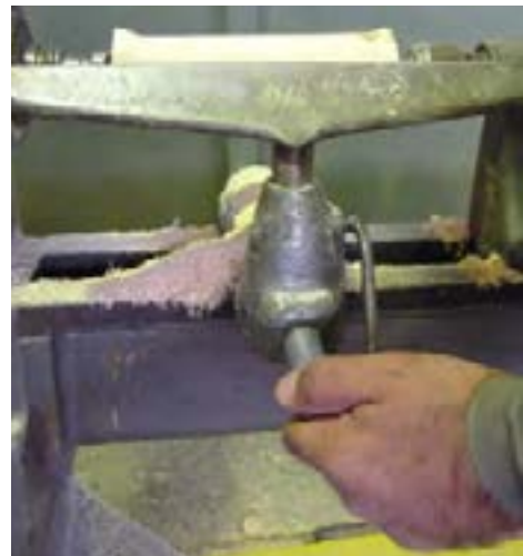
شکل ۱۱-۲۵- تکیه‌گاه کوتاه، و تنظیم ارتفاع و فاصله‌ی افقی آن نسبت به قطعه چوب فراطی.
