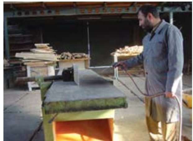
شکل ۱۲-۶- غبارگیری ماشین با شیلنگ باد.
