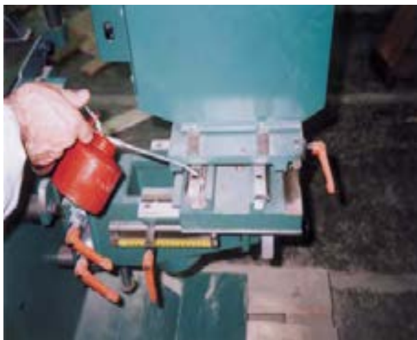
شکل ۱۰-۱۳- (روغن‌کاری) ممل (ریل‌ها).
