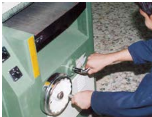
شکل ۱۹-۷- تنظیم صفحه و ممک نمودن اهرم مربوطه.
