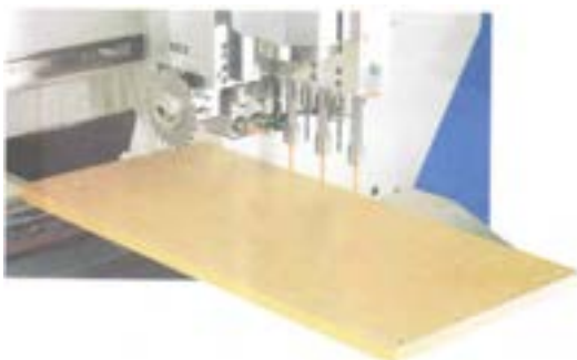
شکل ۵- CNC سوراغ‌کاری و برش‌کاری MDF.
