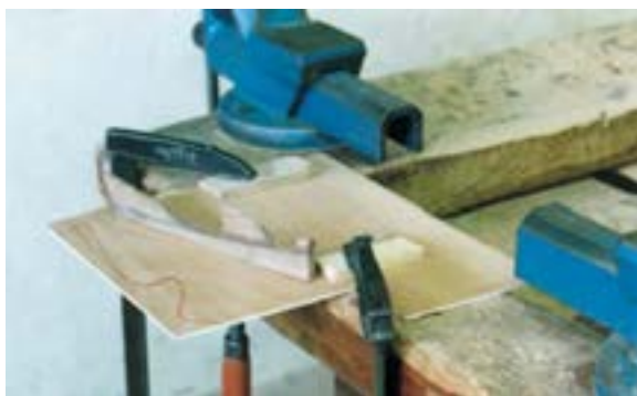
شکل ۱۵-۴۶ - قطعه کار، با روشی درست و با گیره دستی روی میز محکم می‌شود.
