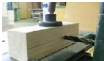
شکل ۹-۱۸- تنظیم نیش مته با فط وسط چوب.
