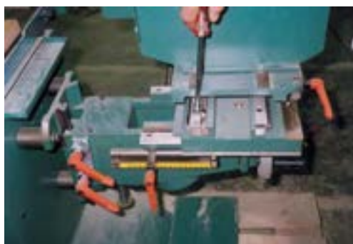
شکل ۱۰-۲۱ - سفت کردن پیچ‌های شل شده.
