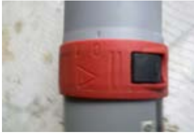
شکل ۱۷-۷ - کلید قطع و وصل دستگاه فرز بیسکویتی
