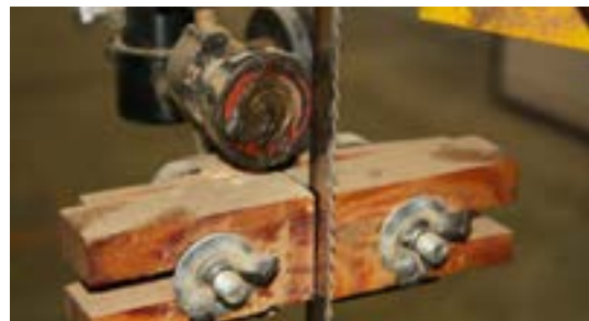
شکل ۳-۲- گریس‌کاری بلبرینگ تیغه اهره.
