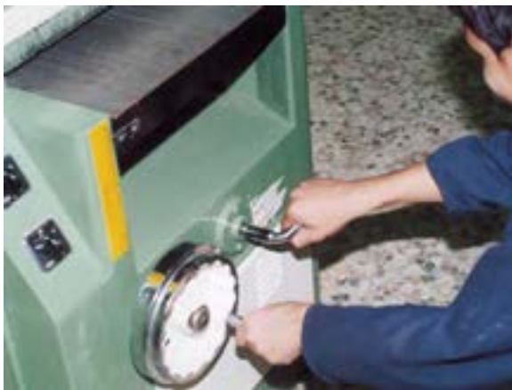
شکل ۷-۳۴- تنظیم مقدار بار گندگی.
