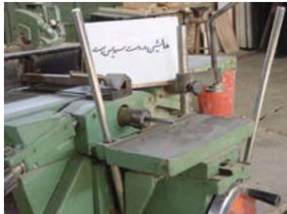
شکل ۱۰-۸- تابلوی هشدار سرویس‌کاری.
