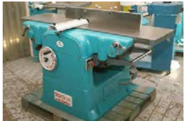
شکل ۴-۴- ماشین کفرند با بدنه چدنی.
