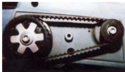
شکل ۹-۱۴- وضعیت قرار گرفتن تسمه روی پیرغ‌دنده.
