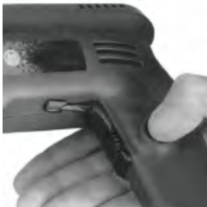
شکل ۱۹-۴۳- (رها کردن کلید و کار دائم دریل.
