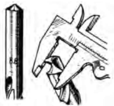
شکل ۱۹-۴۸- اندازه‌گیری قطعه به وسیله‌ی کولیس.
