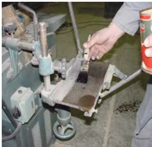
شکل ۱۰-۱۲- چرب کردن صفحات با روغن.
