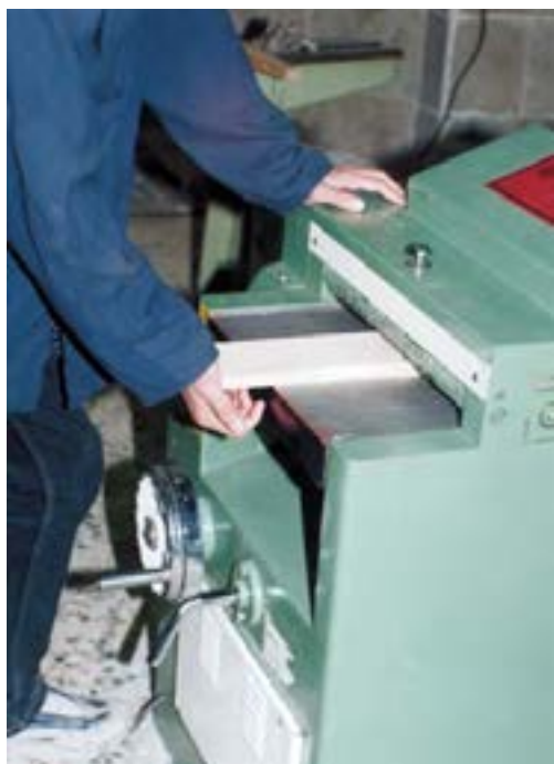
شکل ۷-۴۲- روش ایمنی هدایت چوب به داخل ماشین.
