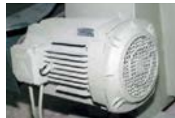
شکل ۵-۱۱- الکتروموتور سه‌فاز یک ماشین خراطی.
