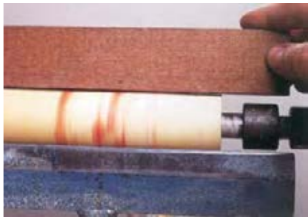
شکل ۱۱-۵۱- کنترل صافی قطعه چوب گرد شده.
