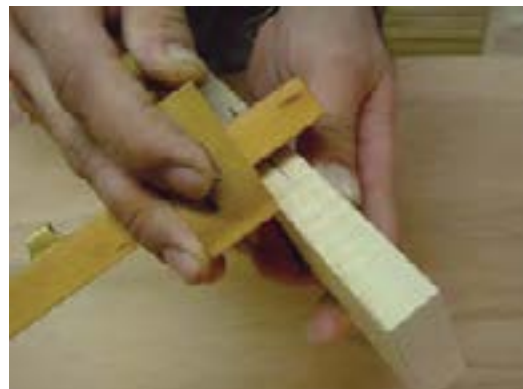
شکل ۹-۱۵- تعیین وسط نر چوب به‌وسیله‌ی فکاش تیره‌دار.
