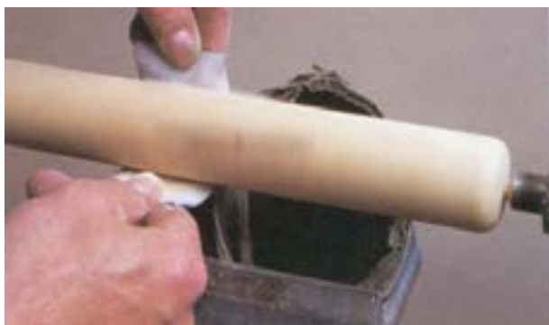
شکل ۱۱-۳۵- به‌وسیله‌ی سنبنده‌ی زبر، چوب فرایندی شده پرداخت می‌گردد.
