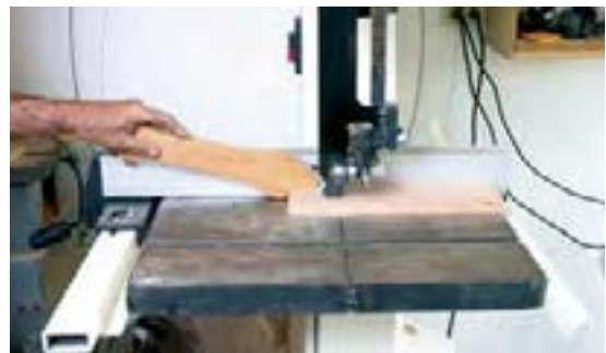
شکل ۵۵-۱. برش چوب‌های باریک به وسیله‌ی چوب کمکی. توجه کنید که برش به انتها نزدیک شده است.
