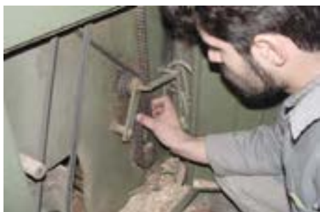
شکل ۲۷-۷. تنظیم و آزمایش سفتی زنجیر انتقال نیرو.
