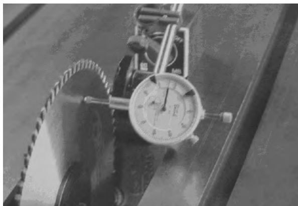
شکل ۱۲-۲۴- کنترل لنگی تیغه با دستگاه لنگی‌سنج.
