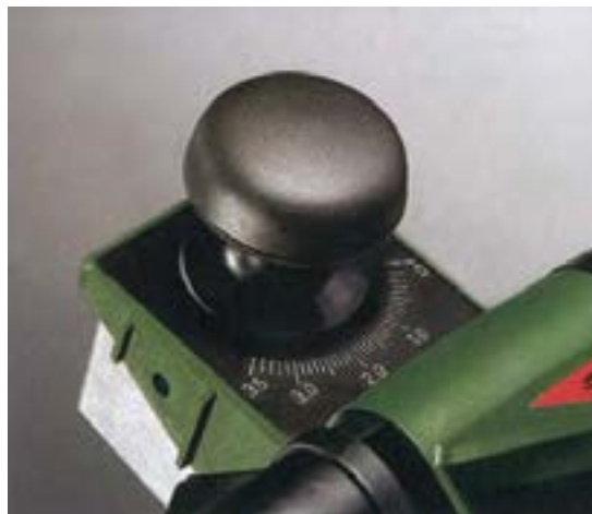
شکل ۴-۱۴. پیچ تنظیم صمفه برای پوشالبرداری
