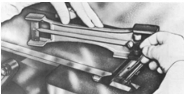
شکل ۹-۵. تنظیم ارتفاع تیغه رنده نسبت به صفحه‌ی خروجی.
