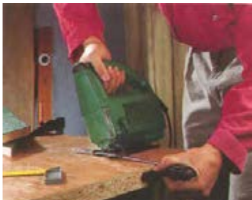
شکل ۲۲-۱۵. نمونه‌ی برش تحت زاویه به کمک گونیا (اره پکشی).
