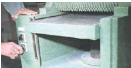
شکل ۷-۳۰- نمونه‌ی ایستادن در هنگام روشن کردن ماشین.
