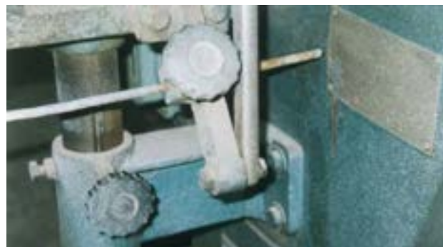
شکل ۹-۸ - سیستم تنظیم عمق کُم.
