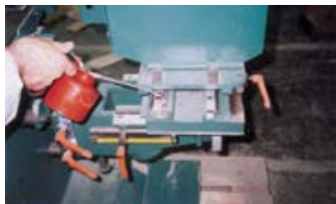
شکل ۱۰-۲۰ - (روغن کاری ریل‌ها).
