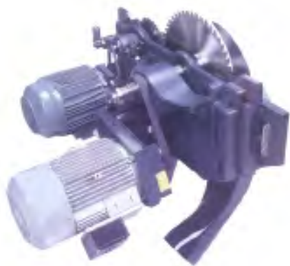
شکل ۱۲-۷- الکتروموتور و سیستم انتقال نیرو.
