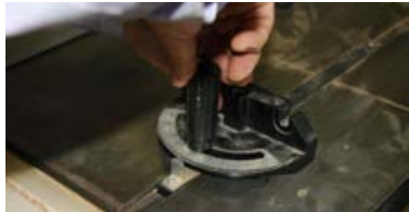
شکل ۱-۵۸- برش عرضی چوب به وسیله‌ی گونیای متحرک (عرضی).
