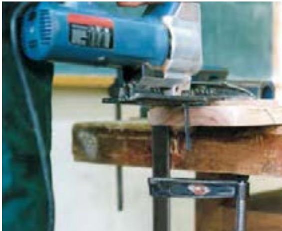
شکل ۱۵-۳۵. صفحه، کاملاً روی چوب قرار نگرفته است.
