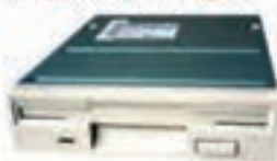
شکل (۴-۴) دیسک گردان دیسک نرم (Floppy Disk Drive)
