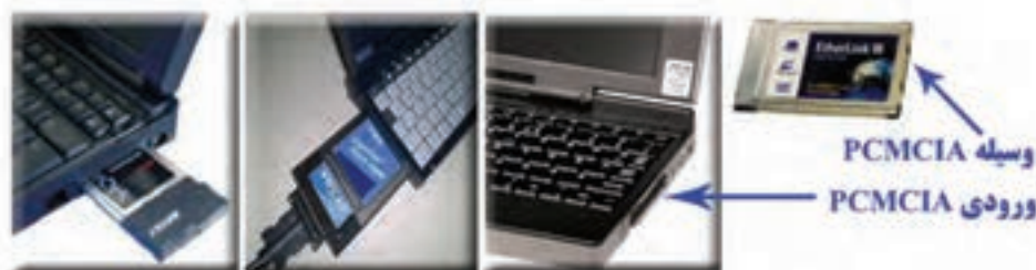
شکل (۵-۱۷) ورودی PCMCIA و کارت شبکه PCMCIA
