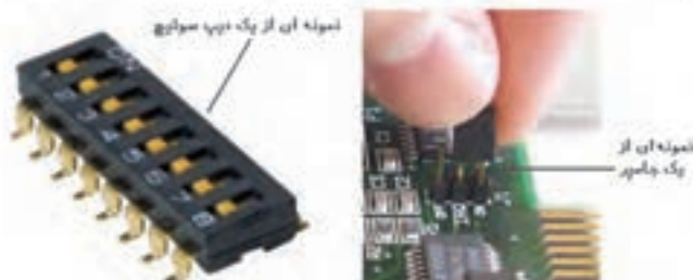
شکل (۵-۱۹) جامپر و دیپ سوئیچ
