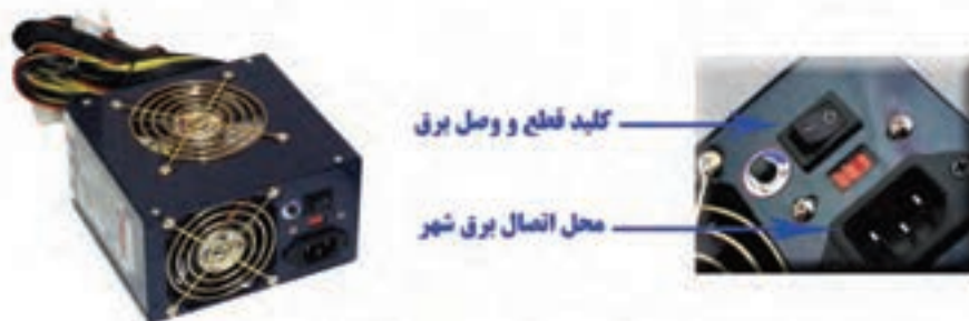
شکل (۲۲-۵) منبع تغذیه یا Power Supply
