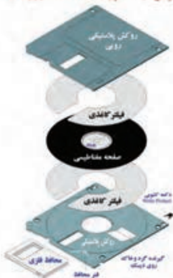
شکل (۴-۵) نمای داخلی یک دیسک نرم 3\frac{1}{2} اینچی
