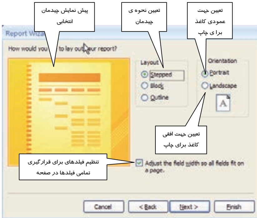
شکل ۳۲-۶ چهارمین پنجره‌ی ساخت گزارش به روش Wizard Report و انتخاب نحوه چیدمان
