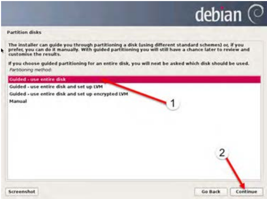
شکل ۴۸-۹ روش تنظیم دیسک سخت
