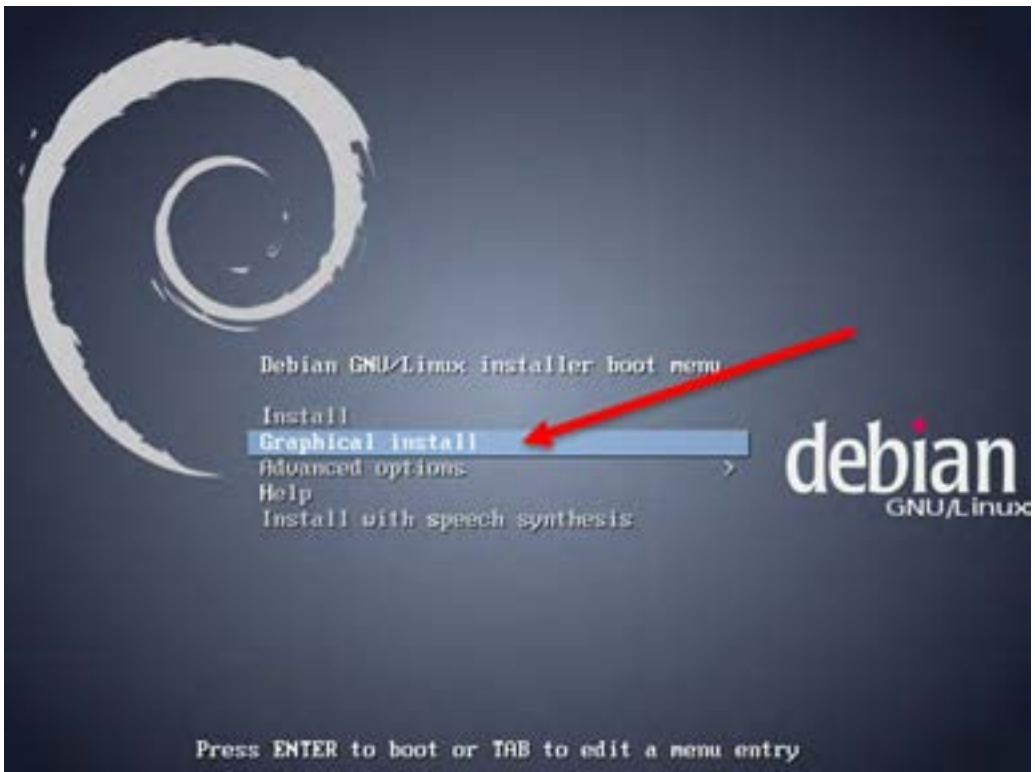
شکل ۳۳-۹- نصب گرافیکی سیستم عامل دبیان
