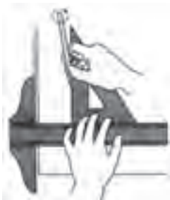
نحوه خط کشی روی لبه گونیا با مداد در جهت قائم
