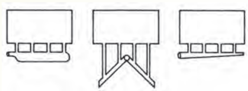
شکل ۱۸-۵. طرح‌های اصلاحی برای ورود یکنواخت مذاب به محفظه قالب در راهگاه‌های مرکب
