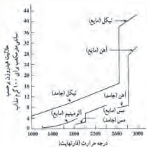
شکل ۱-۲- تأثیر درجه حرارت در حلالیت هیدروژن
