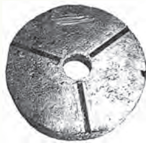
شکل ۲-۷- نمونه از قطعه با عیوب آخال و مک‌های میکروسکوپی
