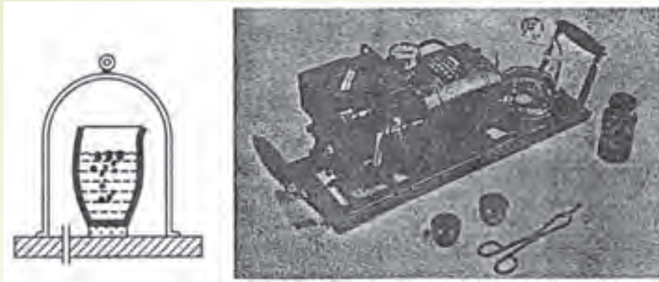
شکل ۶-۲- اندازه‌گیری گاز تحت شرایط خلأ
