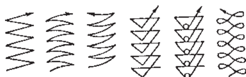
شکل ۳-۳۲ – حالت‌های مختلف حرکت نوسانی نوک الکتروود
