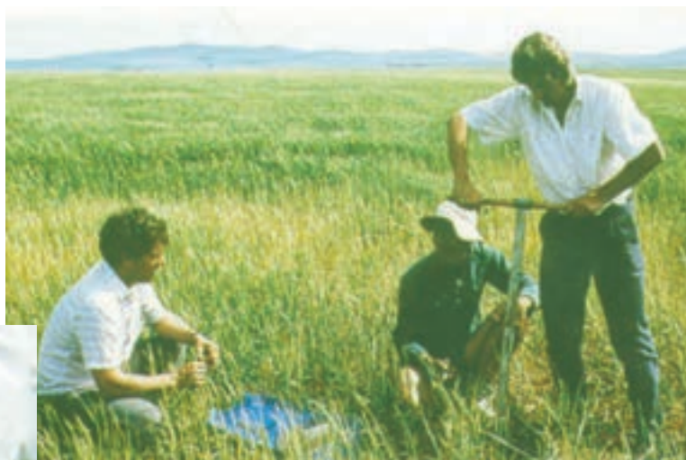
شکل ۱۳-۱ نحوه کار با اوگر
