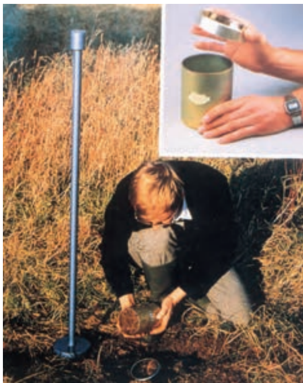
شکل ۱۶- ۱ نمونه برداری از خاک با سیلندر
