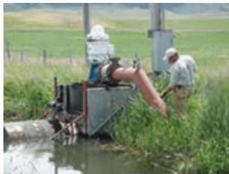
شکل ۱-۱- پمپ در حال انتقال آب از کانال
