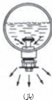
شکل ۵۲-۷- وضعیت کار سوپاپ تخلیه
