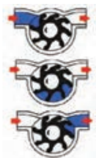
شکل ۱۶-۳- طرز کار پمپ
