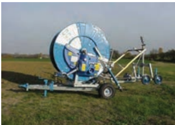
شکل ۶۵-۷. ارابه در وضعیت جمع شده کامل
