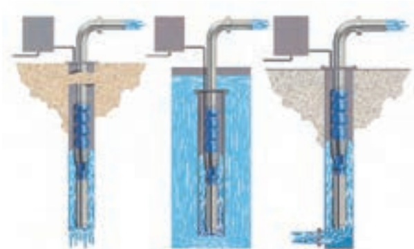
شکل ۵-۵- حالات مختلف نصب پمپ شناور
