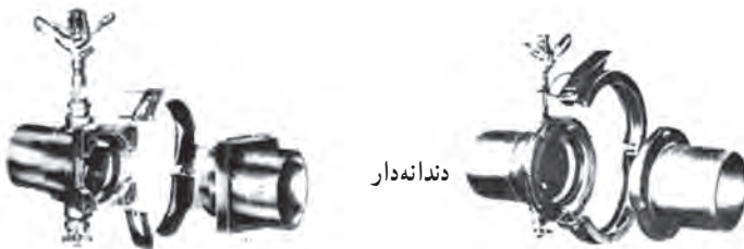
شکل ۷-۵۰- انواع اتصال لوله‌های فرعی در ماشین ویلمو
