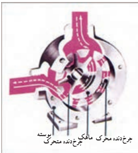
شکل ۳-۵- طرز جریان سیال در پمپ دنده داخلی
