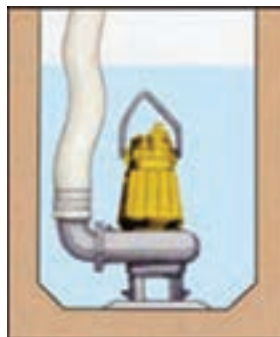
شکل ۸-۵- نصب پمپ کفکش در چاهک
