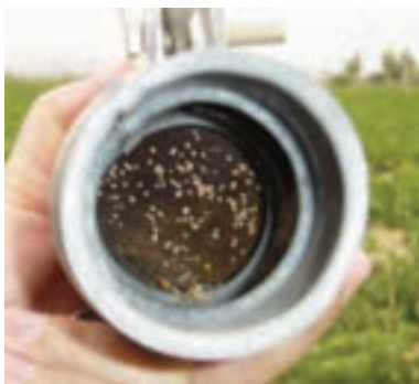
شکل ۱۸-۷- صافی (فیلتر) در مسیر لوله نیمه اصلی
