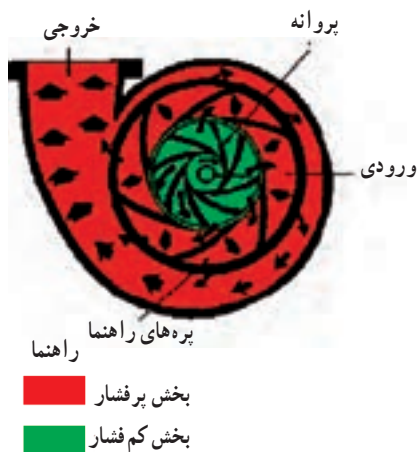
شکل ۲-۷- جریان مایع در پمپ گریز از مرکز
