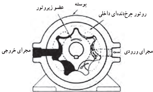
شکل ۳-۷- طرز کار پمپ ژیراتور
