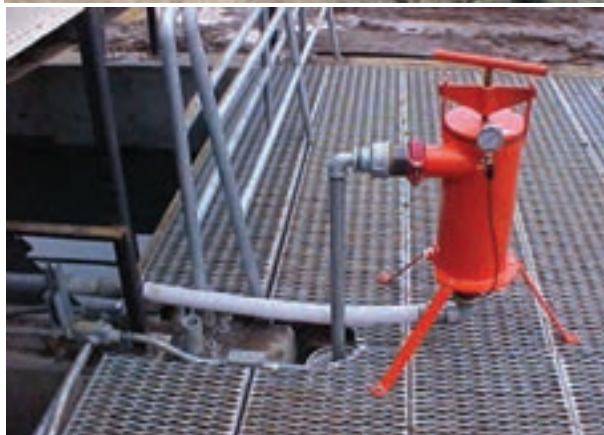
شکل ۲۶-۶- تأسیسات و تشکیلات یک فیلتر توری دار
