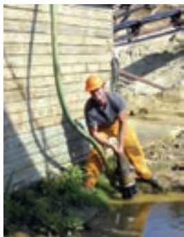
شکل ۲-۳۲- کاربرد پمپ کفکش
