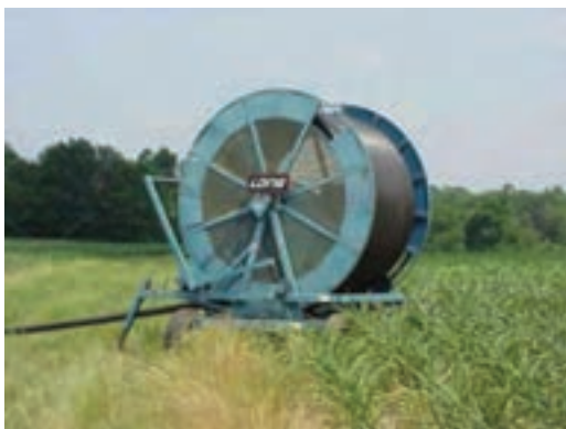
شکل ۶۲-۷ ماشین آبیاری قرقره‌ای مستقر شده در مزرعه با لوله باز شده
