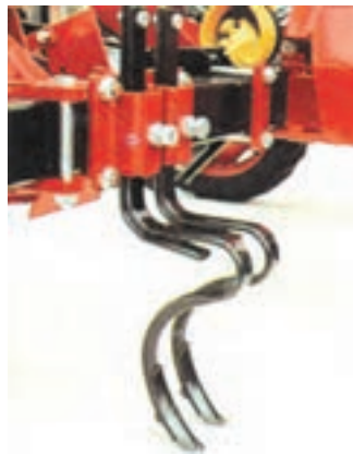
شکل ۷-۱۰- دندانه‌های پاک کننده اثر چرخ
