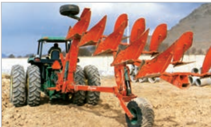
شکل ۱-۱- گاوآهن دوطرفه در وضعیت حمل
