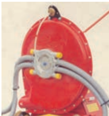
شکل ۷-۱۳ پمپ مکنده و درجه باد
