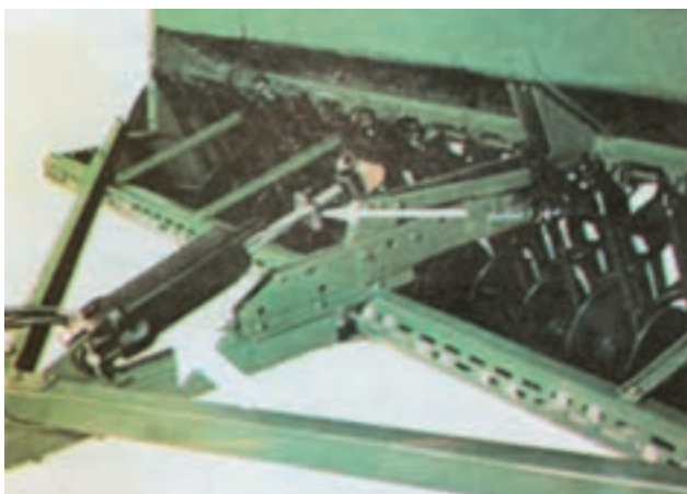
شکل ۱۵-۶- تنظیم عمق کاشت توسط جک هیدرولیک
