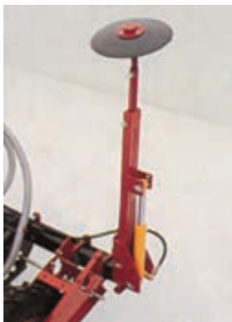
شکل ۷-۱۲ علامتگذار و جک هیدرولیکی متصل به آن
