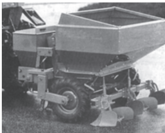
الف — پشته‌ساز نصب شده روی غده کار
