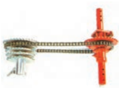
شکل ۱۱-۸- زنجیر و چرخ زنجیر سیستم محرک موزع
