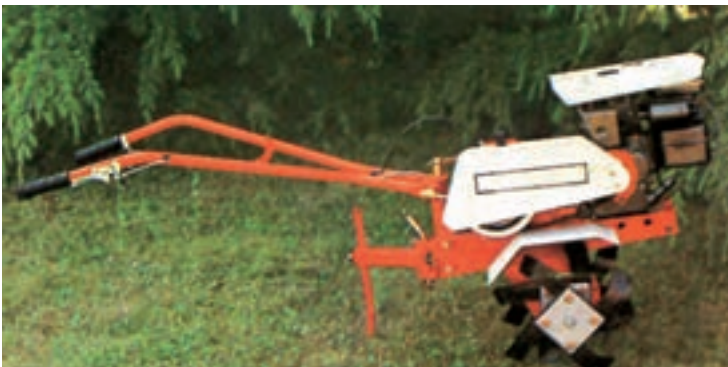
شکل ۷-۴- گاو آهن دوار مخصوص تیلر
