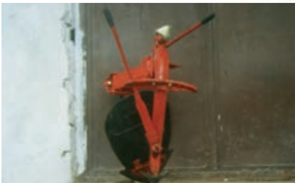
شکل ۴-۴- گاواهن با برگردان صاف و ادوات تنظیم
