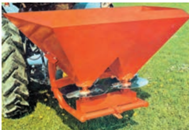
شکل ۵-۲- بذرپاش تراکتوری سوار
