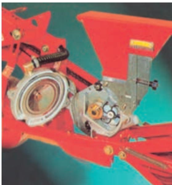
شکل ۷-۱۶- تعویض صفحه بذر
