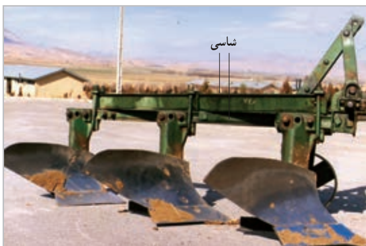
شکل ۱۸-۱ شاسی در گاواهن دار سه خیشه سوارشونده
