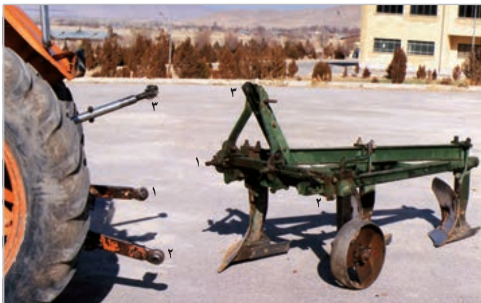
شکل ۲۰-۱- نقاط سه گانه اتصال گاوآهن و تراکتور
