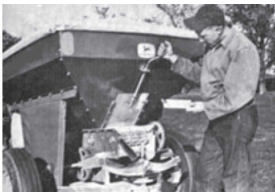
شکل ۵-۷ — اهرم کنترل دریچه
