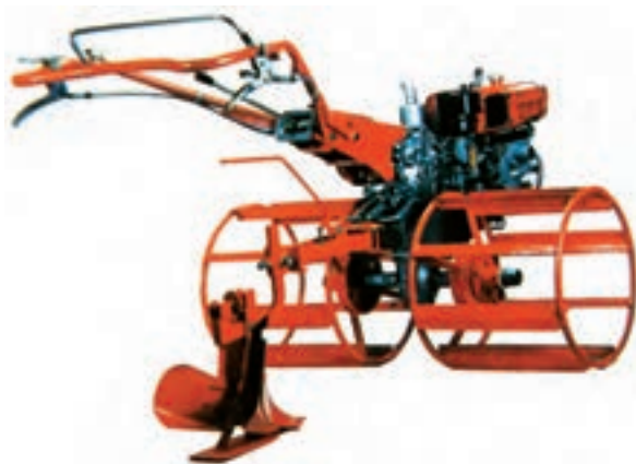
شکل ۵-۴- تراکتور دو چرخ مجهز به شیار کش و چرخهای مخصوص باتالاق
