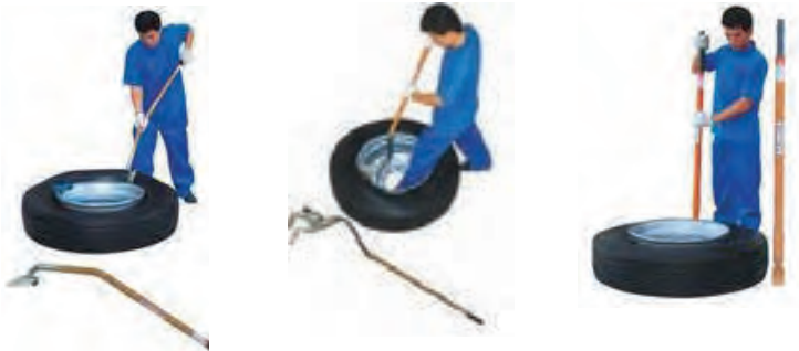
شکل ۳-۵ - اهرم‌های دستی برای جدا کردن تایر از روی رینگ
