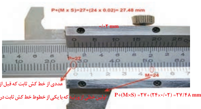
شکل ۱-۲۳- قرائت کولیس
