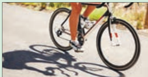
شکل ۹-۲- انتقال نیرو به وسیله زنجیر
