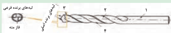
شکل ۵۰ - ۱- اجزای مته مارپیچی
