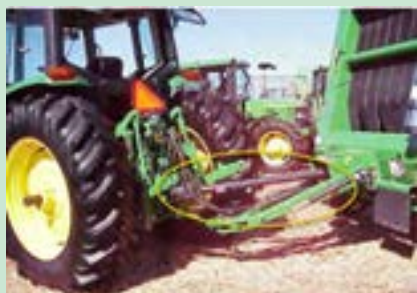
شکل ۴-۹- اتصال شیلنگ های هیدرولیک (الف) (ب)
