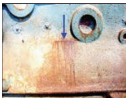
شکل ۴۴- ۲- ترکیدن بلوک سیلندر در اثر سرما
