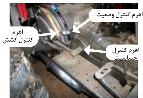
شکل ۳-۵۹- اهرم‌های کنترل هیدرولیک تراکتور فرگوسن ۲۸۵
