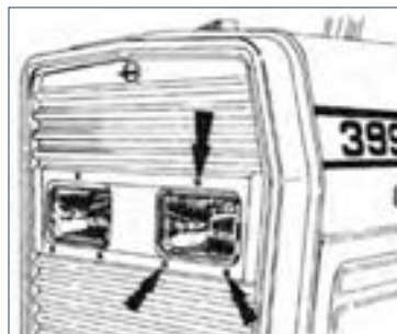
شکل ۱۸-۳ پیچ های تنظیم چراغ
