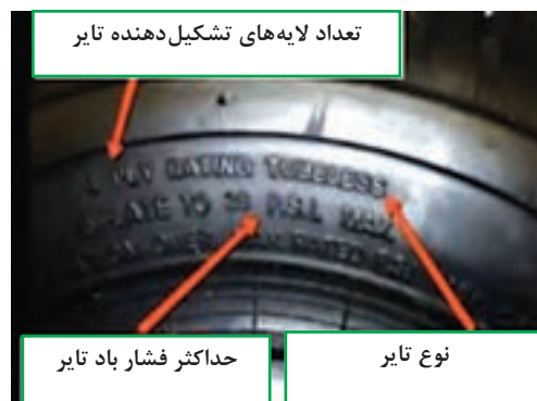
شکل ۱۷-۵- مشخصات فنی تایر
