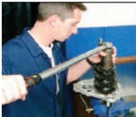
شکل ۱۲-۱ کار با ترک متر قابل تنظیم
