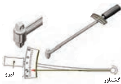
شکل ۱۳-۱ ترک متر عقربه‌ای
