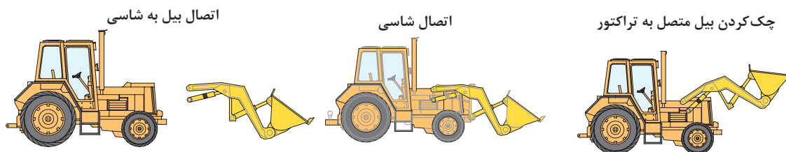
جدول ۷- ۴- مراحل اتصال بیل به تراکتور
