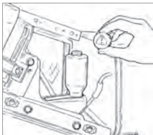
شکل ۴۸-۲- بازدید روغن ترمز در تراکتور فرگوسن ۳۹۹
