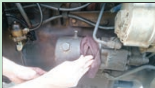
شکل ۴۱-۳ تمیز کردن پوسته روغن فرمان
