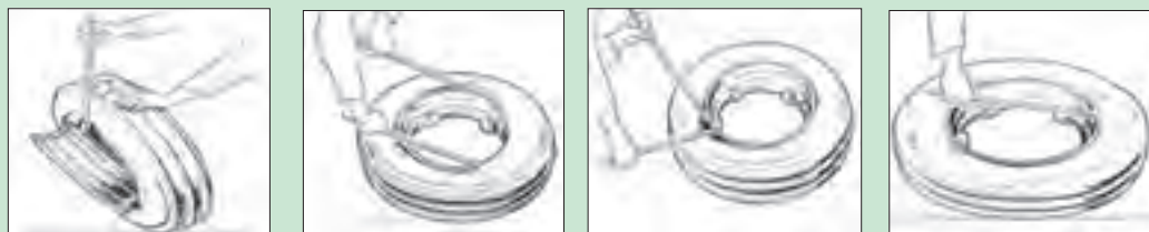
شکل ۲۵-۵ جدا کردن تایر از رینگ یک تکه
