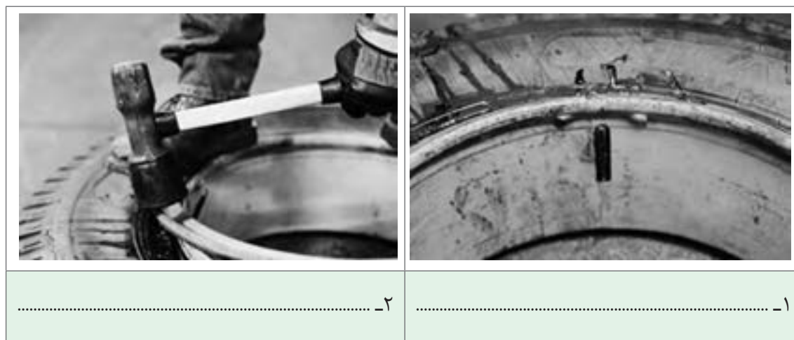
شکل ۳۲-۵- جازدن تایر روی رینگ دو تکه
