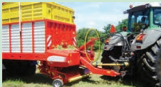
شکل ۴-۹- اتصال شیلنگ های هیدرولیک (الف) (ب)
