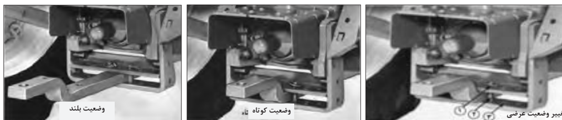
شکل ۵۷-۳ تنظیمات مالبند قابل تنظیم
