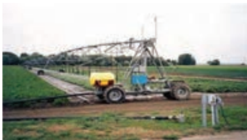
الف) اتصال لوله ورودی به شیر هیدرانت
