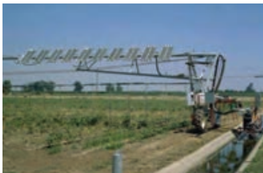
الف) دستگاه لینیئر با اسپن یک طرفه
