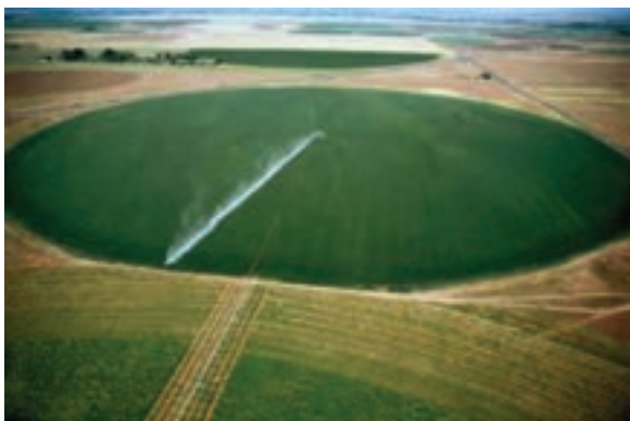
ب) دستگاه سنتریوت در حال آبیاری
