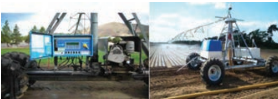
الف) استفاده از موتور احتراقی در دستگاه لینیئر
