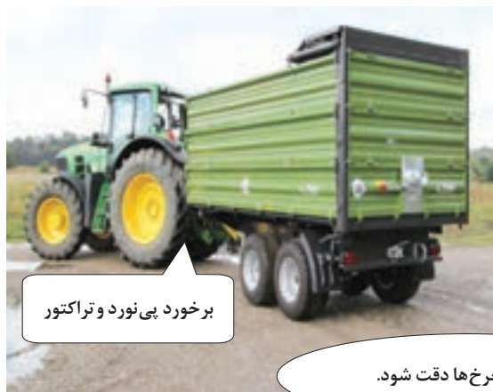
شکل ۴-۱۱- تراکتور متصل به پی نورد در حین تغییر جهت
