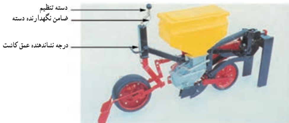
شکل ۷-۱۷- دسته تنظیم عمق پس از خواباندن ضامن با چرخاندن دسته، چرخ فشار بالا و پایین رفته و عمق کاشت را تغییر می‌دهد.
