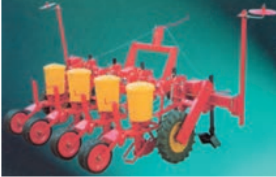
شکل ۷-۱- ردیف کار مکانیکی
