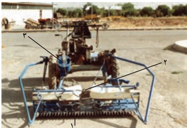
۱- شانه برش ۲- دهانه دسته‌بند ۳- محفظه محتوی دوک نخ شکل ۸-۸- واحد درو دسته‌بند و اجزای آن
