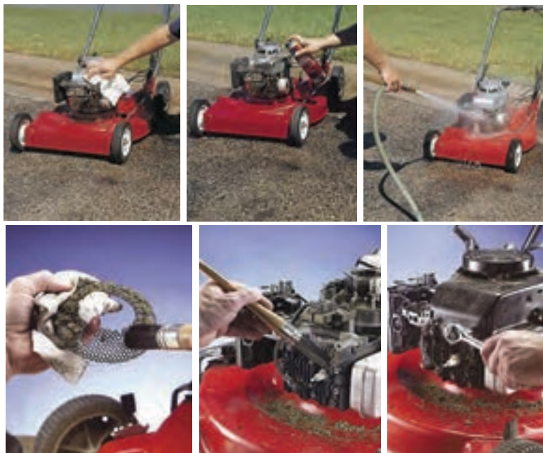
شکل ۵ - ۶ - مراحل شست‌وشوی چمن زن برای آغاز تعمیر است.
