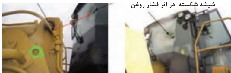
شکل ۹- ۵- شکستن شیشه بولدوزر در اثر نشستی و فشار روغن هیدرولیک
