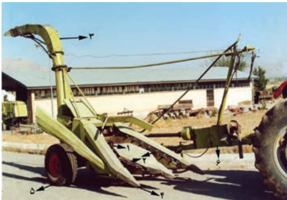
۱- غلتک‌های تغذیه ۲- زنجیرهای هادی ۳- لوله هادی ۴- ناخن ۵- چرخ حامل ۶- محور انتقال نیرو شکل ۲-۷- ذرت خردکن کششی دو ردیفه
