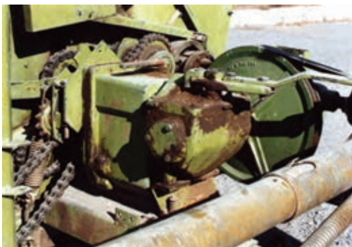
شکل ۷-۸- جعبه دنده ها و اجزای انتقال قدرت
