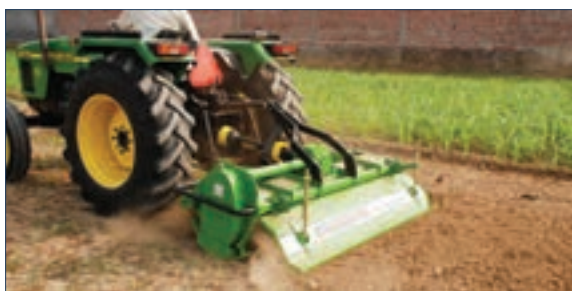
شکل ۳-۶۷- گاوآهن دوار
