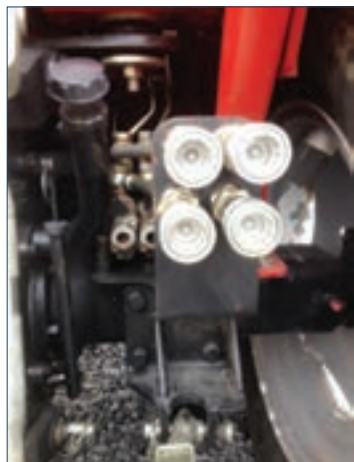
شکل ۶۴-۳- خروجی هیدرولیک
