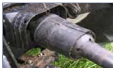
شکل ۳-۷۳- گاردان مجهز به کلاچ یک‌طرفه
