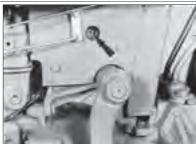
شکل ۳۹-۳- بازدید سطح روغن جعبه فرمان تراکتور ۲۸۵
