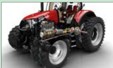
شکل ۱۹-۳- سیستم انتقال توان
