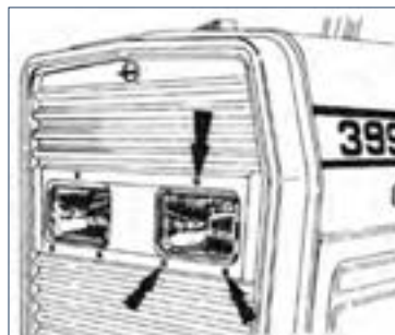
شکل ۱۸-۳ پیچ های تنظیم چراغ
