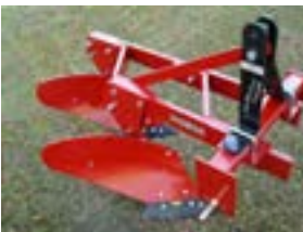
شکل ۳-۵- انواع گاو آهن برگرداندار از نظر تعداد خیش
