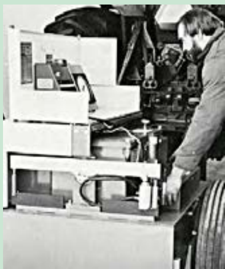
شکل ۳۵- برای اندازه گیری توان تراکتور از دستگاهی به نام دینامومتر استفاده می شود.
