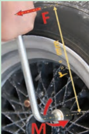
شکل ۱۰-۶- باز کردن پیچ چرخ خودرو توسط آچار چرخ
