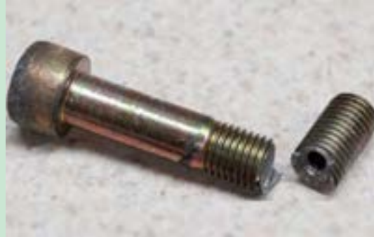
شکل ۲۹-۶ یک پیچ بریده شده بر اثر بارگذاری پیچشی
