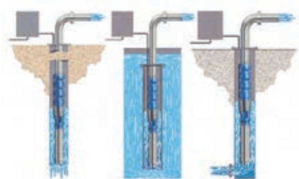
شکل ۵-۵- حالات مختلف نصب پمپ شناور
