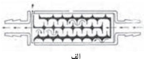
شکل ۶-۶ - گسیلنده طولانی مسیر نوع Lego (غیر یکنواخت) نمایش تفصیلی
